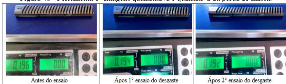
Figura 48 - Ferramenta 1- Imagens quantitativa e qualitativa da perda de massa.
