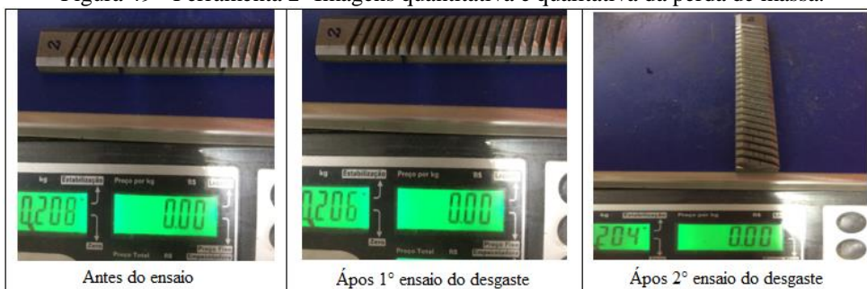
Figura 49 - Ferramenta 2- Imagens quantitativa e qualitativa da perda de massa.
