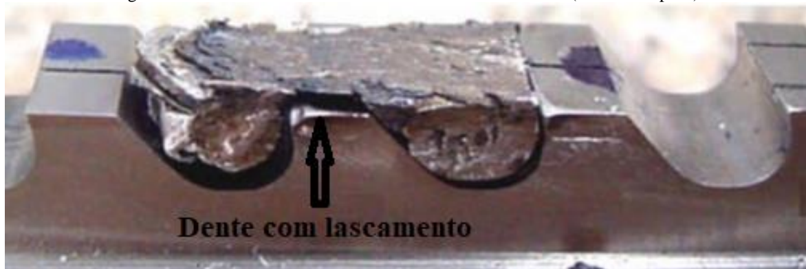
Figura 16 - Dente com lascamento devido acúmulo de cavaco (falta de limpeza).
