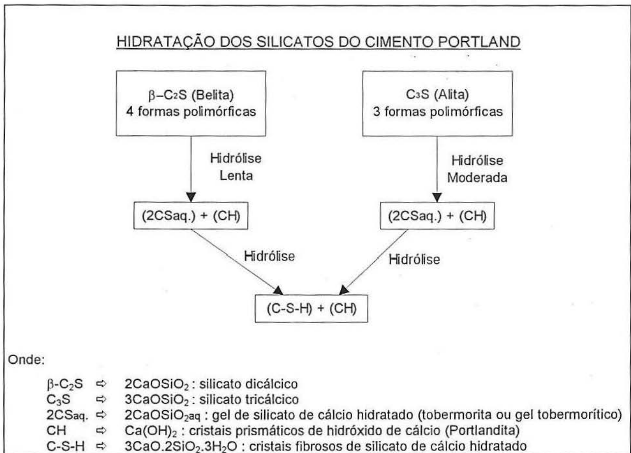
Figura 2.2 Representação esquemática das reações durante a hidratação dos silicatos do cimento Portland
