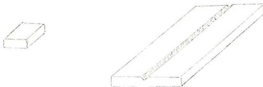
Figura 12 - Formatos dos corpos de prova utilizados na realização das experiências de oxidação e de conformação a partir de temperaturas elevadas.
