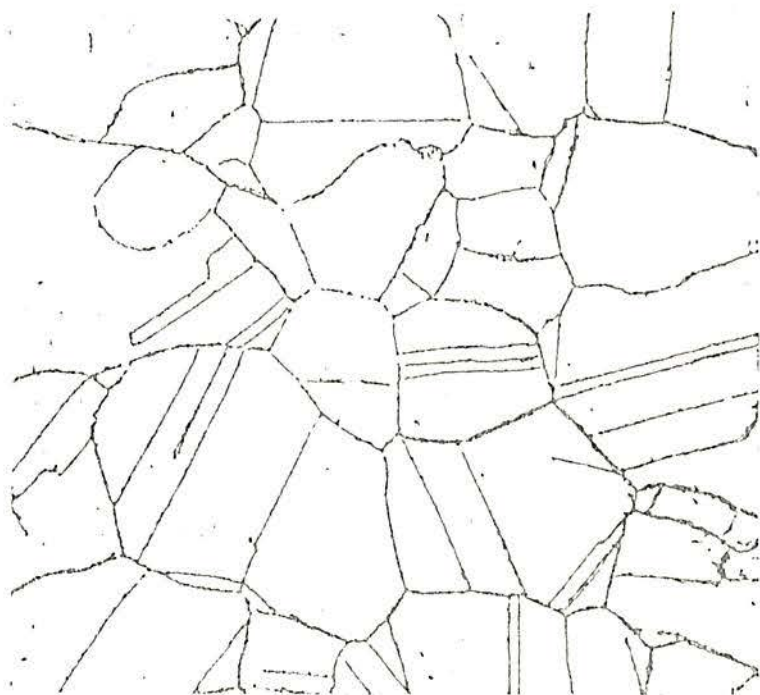
Figura 7 - Mesmo aço da fig.6 após a precipitação de carbonetos, principalmente junto aos contornos de grão; x 1000.
