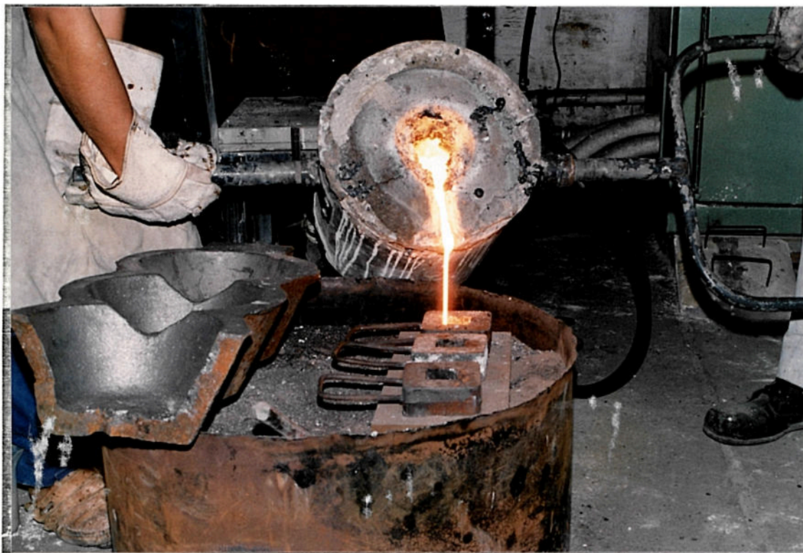
Fig. 20 - Fotografia da operação de vazamento.
