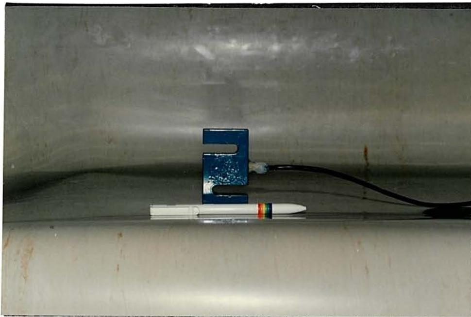
Figura 7.4.5 - Célula de carga tipo "S", com furo circular, de 5500 N de capacidade. Os extensômetros estão colados internamente ao furo circular, o qual foi posteriormente preenchido com silicone visando a proteção mecânica da fiação.
