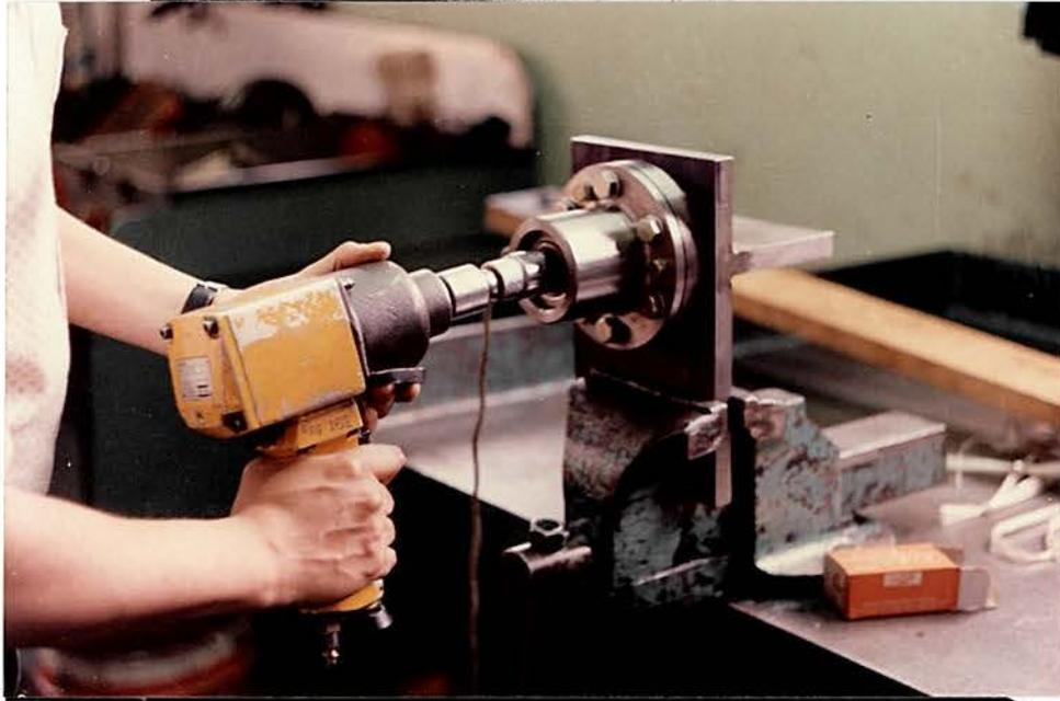
*Figura 7.9.3 - Detalhe de uma aparafusadeira sendo testada com o torquímetro da figura 7.9.2. Este ensaio foi realizado na empresa SLC, de Horizontina, RS.*
