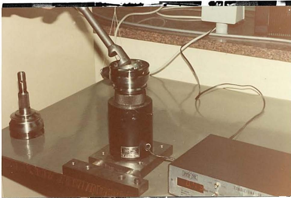
Figura 7.8.5 - Vista do torquímetro de 8 Nm usado no controle de qualidade, na montagem industrial da gaiola de esferas em juntas homocinéticas automotivas, na ATH Albarus S.A., em Porto Alegre.
