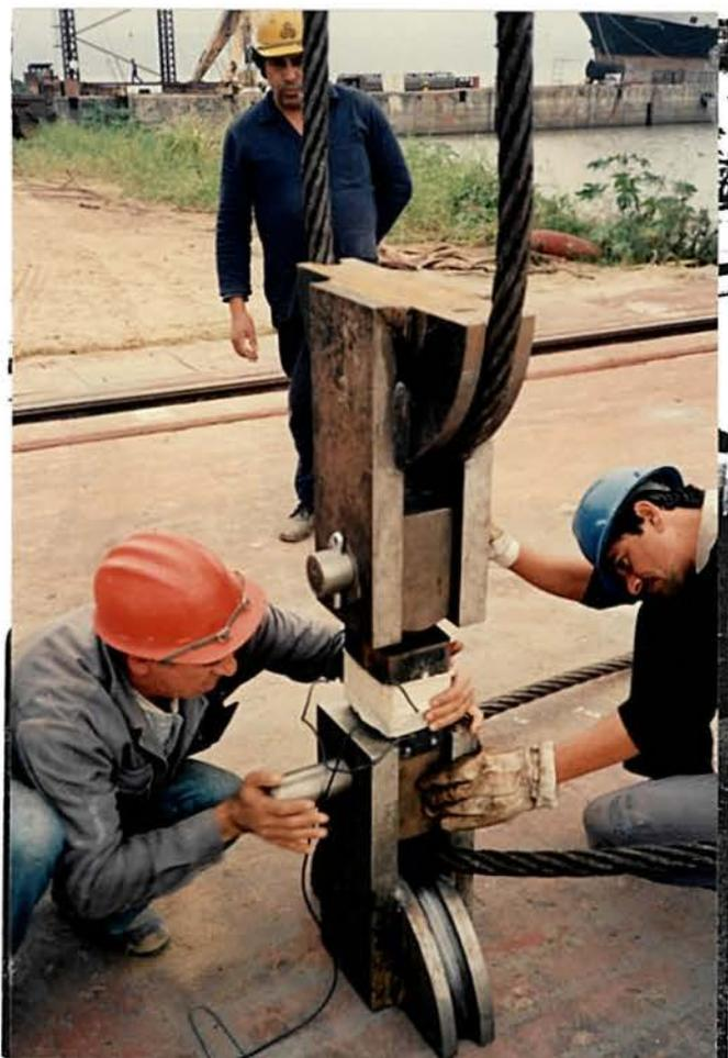
*Figura 7.2.3 - Aspecto da montagem da célula de carga de 500 kN, realizada no Estaleiro Só S.A., em Porto Alegre.*
