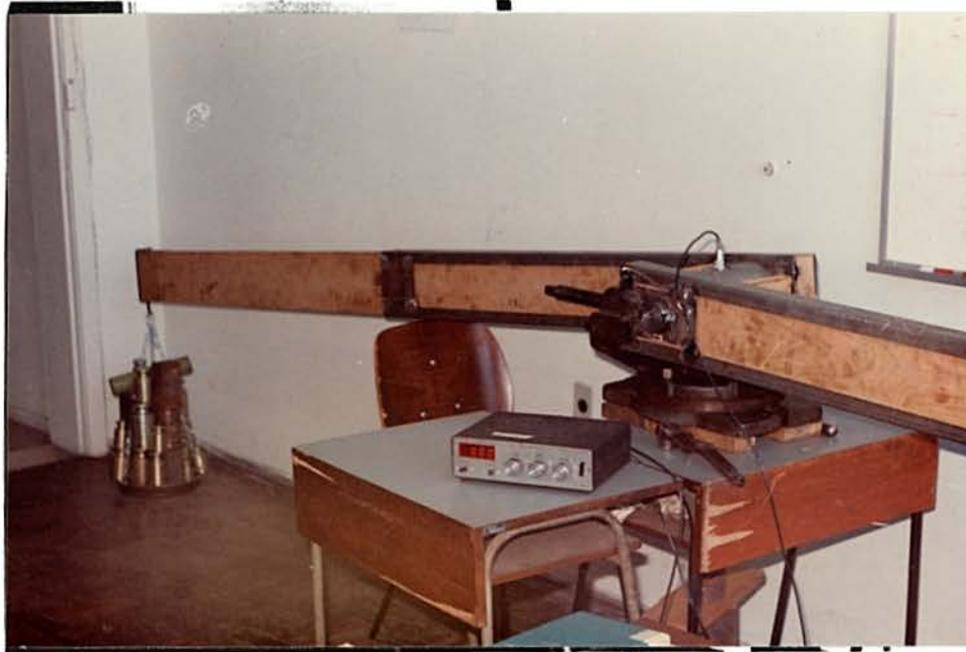
Figura 7.9.5 - Aspecto montagem para a calibração do torquímetro de 4420 Nm.
