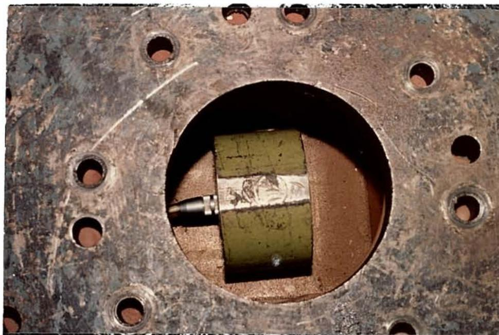
*Figura 7.5.6 - Vista superior da célula de carga da figura 7.5.5, posicionada para teste de atuadores, realizados nas Indústrias Micheletto S.A., em Canoas.*
