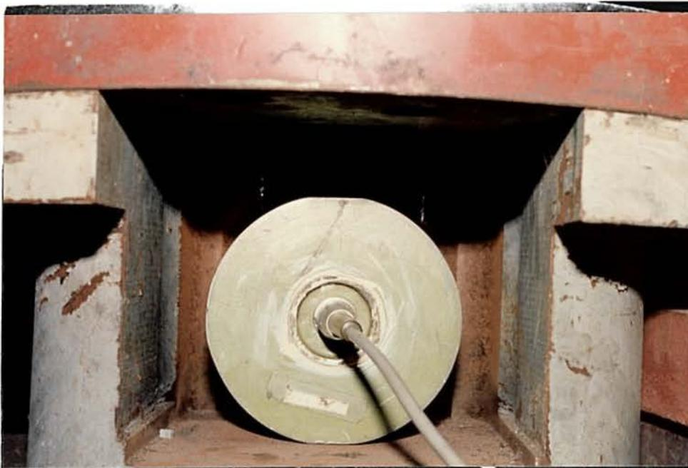
Figura 7.5.5 - Aspecto do posicionamento da célula de carga de 400 kN, usada para medida de força em atuadores. O fuso do atuador pressiona a parte superior da célula.
