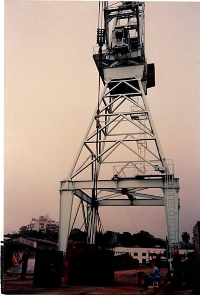
*Figura 7.2.4 - Aspecto da realização do ensaio para calibração da célula de carga de 500 kN, usando-se massas conhecidas e suspensas por um guindaste. Uma dificuldade extra deste ensaio foi a existência de interferências eletromagnéticas provocadas por diversas estações radiotransmissoras próximas ao guindaste, que funcionava como uma antena, exigindo assim o uso de filtros de RF no condicionador de sinais.*
