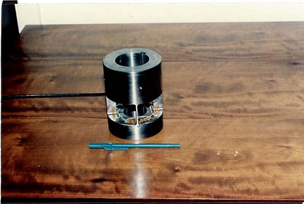
Figura 7.8.4 - Aspecto do elemento elástico do torquímetro cruciforme vazado de 8 Nm, com oito extensômetros, sendo arranjados dois em cada braço da ponte de Wheatstone.
