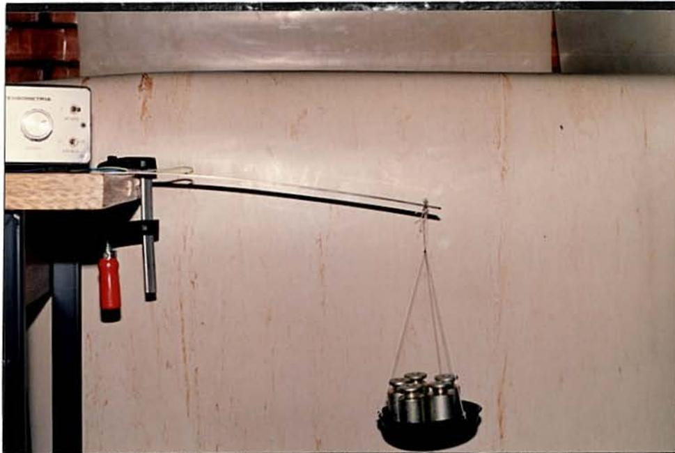
Figura 7.1.2 - Aspectos de uma lâmina engastada, sob a ação de uma força que provoca a sua flexão. Os extensômetros estão colados próximos ao engaste. Este tipo simples de construção encontra a sua grande aplicação em atividades didáticas com extensômetros.
