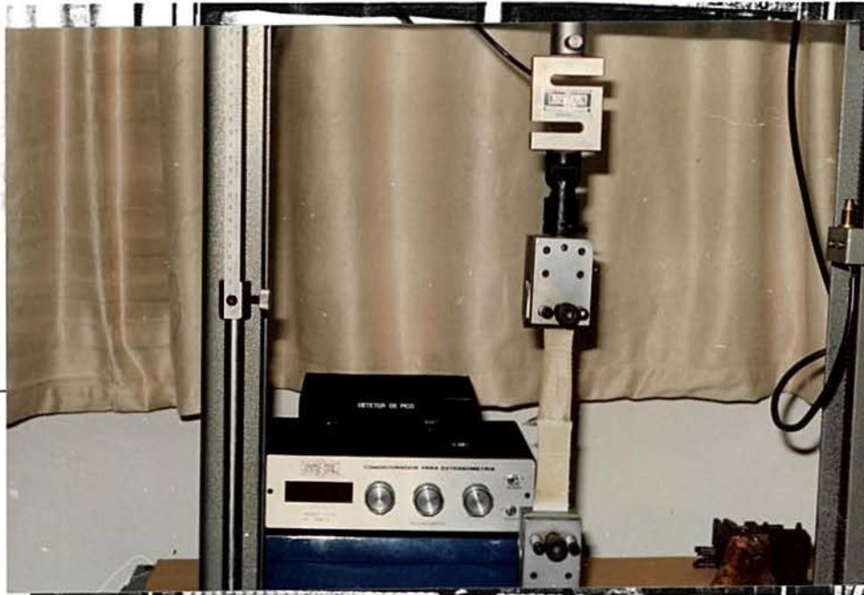
Figura 7.3.4 - Execução do ensaio de tração em couros, na Golden Export S.A., em Novo Hamburgo.
