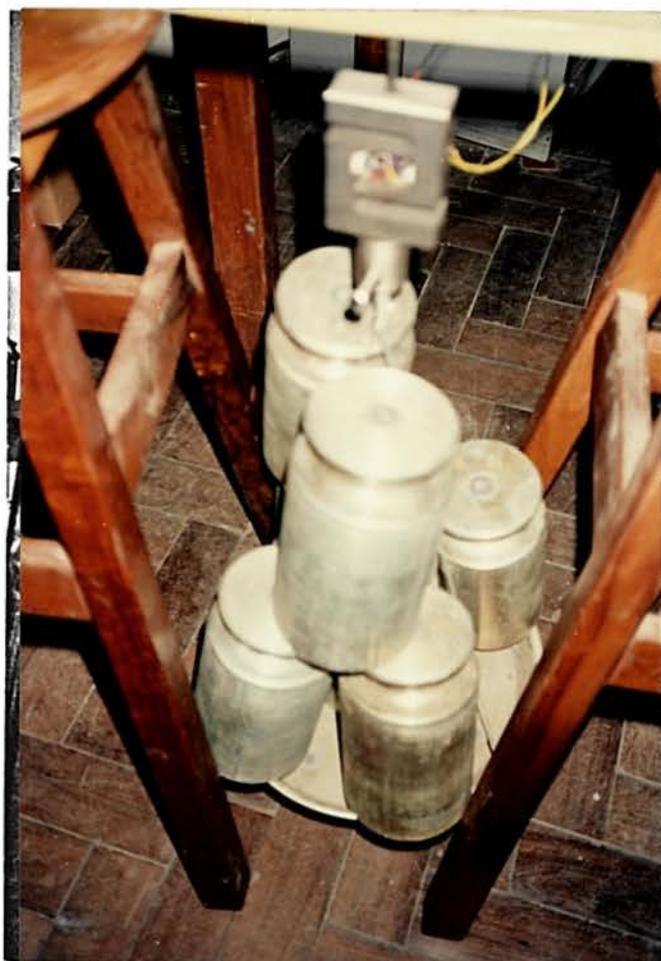
Figura 7.3.3 - Realização do ensaio de calibração da célula tipo "S", com furo retangular de 1000 N de capacidade, através do uso de massas de 10 kg.
