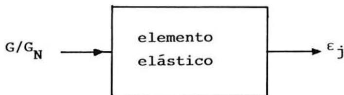
Figura 5.2 - Representação do elemento elástico de um TE, apresentando um conjunto de deformações  $\epsilon_j$  em sua superfície, devido a grandeza mecânica  $G/G_N$ .
