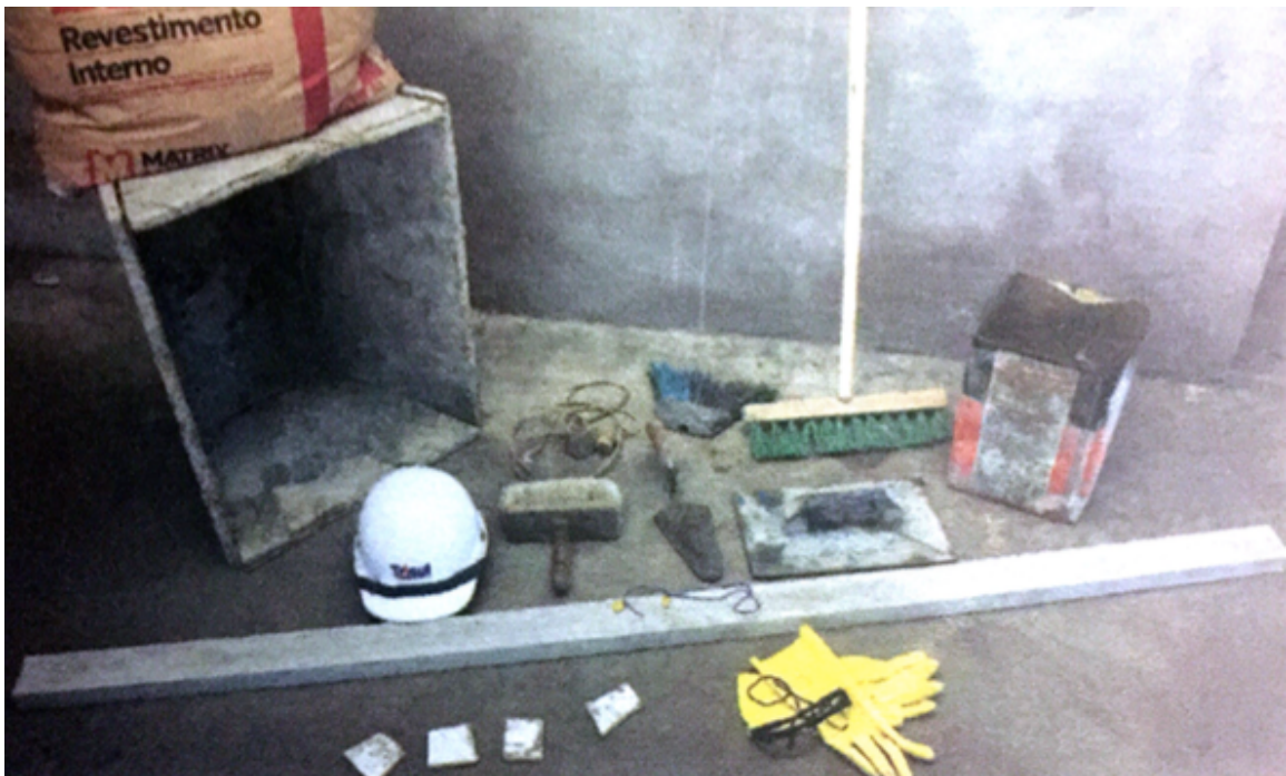
Figura 20 – Materiais utilizados para execução de serviços de revestimento argamassado
