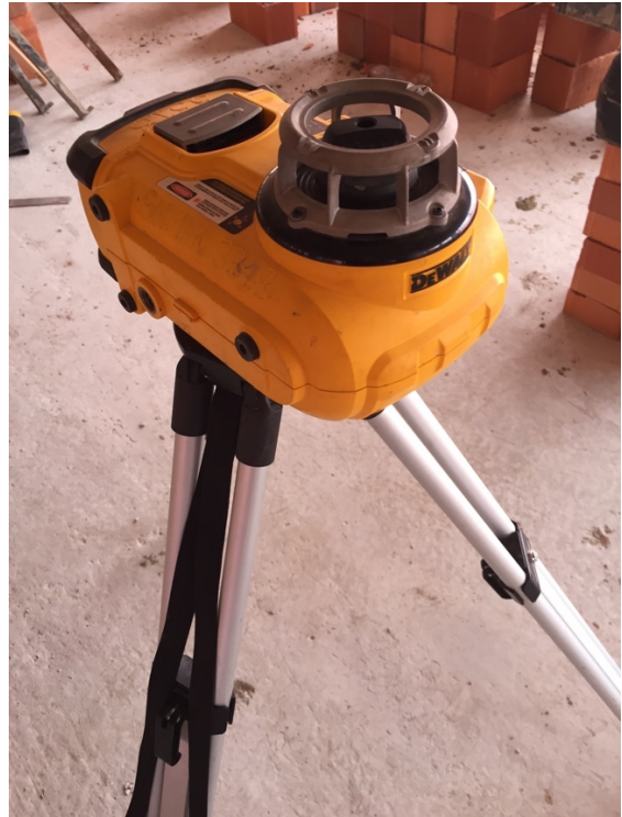
Figura 37 (b) – Nível a laser utilizado
