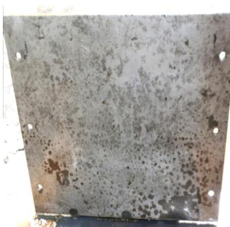
Figura 22 – Superfície de fôrma em estado deteriorado de conservação (LIBESSART et al., 2014)
