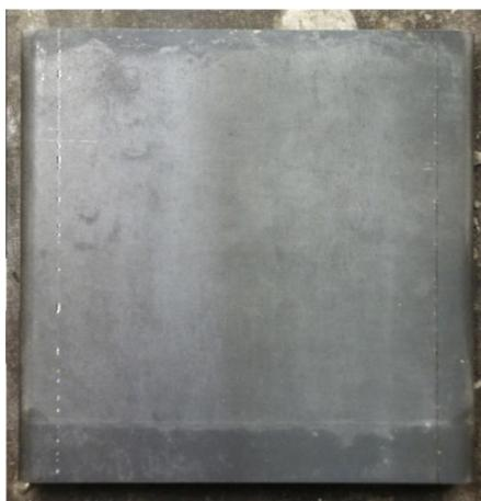
Figura 21 – Superfície de fôrma em bom estado de conservação (LIBESSART et al., 2014)
