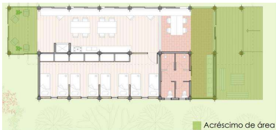
Figura 12 – Acréscimo de área à construção original
