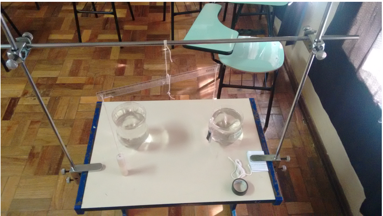
Figura 5: A possível balança de água de Arquimedes, construída de maneira improvisada. Um dos objetos é um tarugo de náilon, o outro é um pequeno saco plástico, bem vedado e com muito pouco ar em seu interior, contendo pregos metálicos. O aparato funciona bem, apesar de não ter sido fácil montá-lo na escola. Fonte: acervo pessoal.
