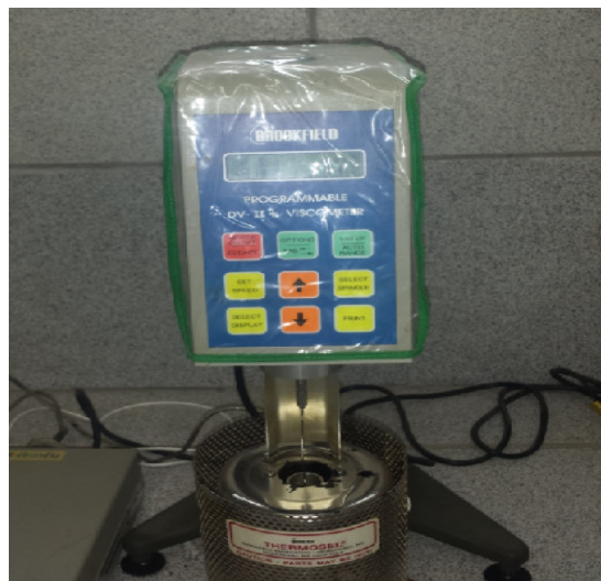
Figura 26: Execução do Ensaio de Viscosidade
