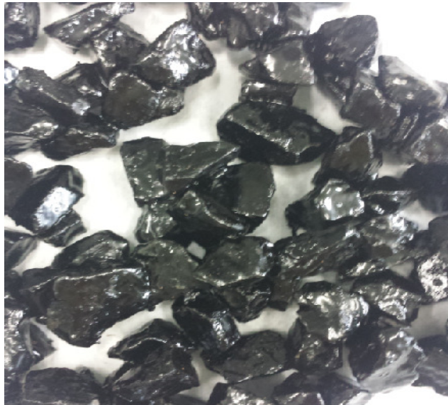
Figura 24: Com cal (sem descolamento)
