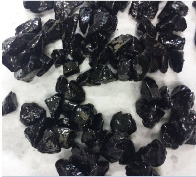
Figura 23: Sem cal (descolamento)
