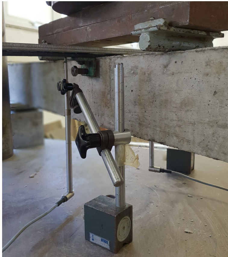
Figura 42 – Detalhe do posicionamento dos LVDTs
