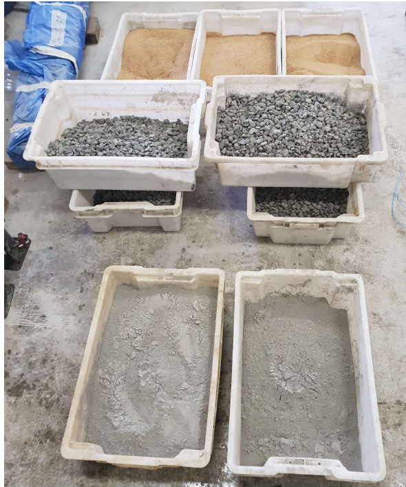
Figura 22 – Separação do material utilizado na concretagem
