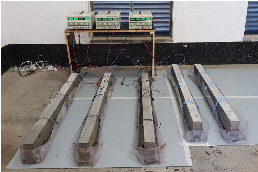
Figura 26 – Configuração geral do ensaio de corrosão
