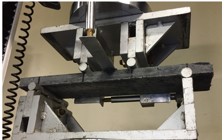
Figura 18 – Configuração dos equipamentos para realizar os ensaios de resistência à tração na flexão em vigas quatro pontos
