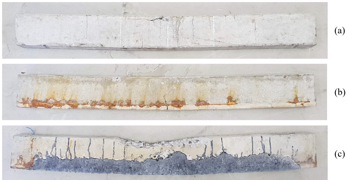
Figura 56 – Vigas após ensaio de flexão
