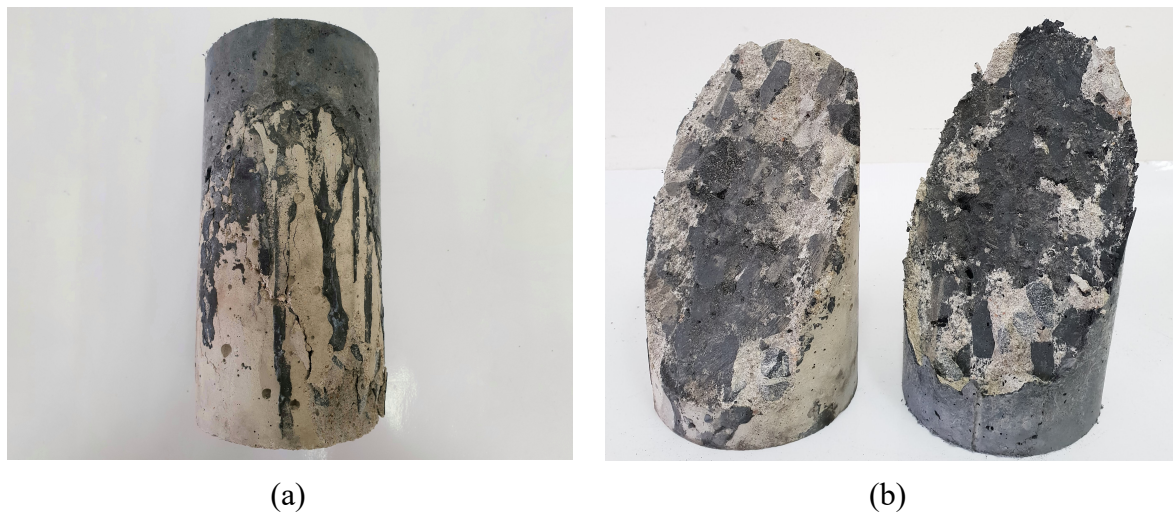
Figura 53 – Ruptura dos corpos de prova
