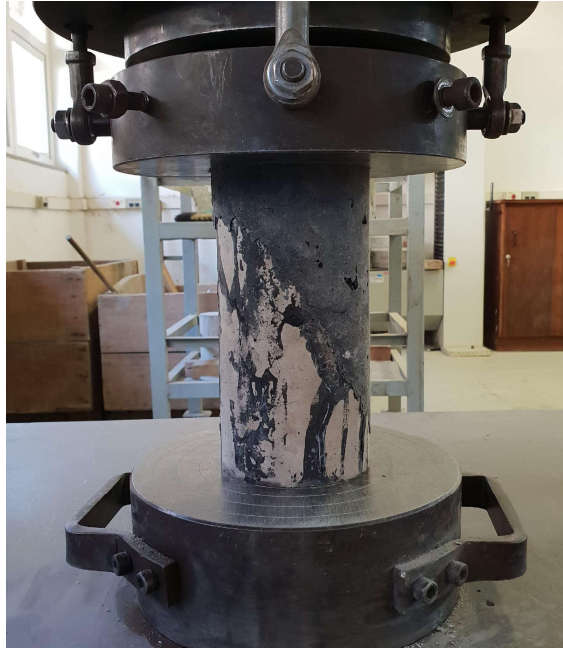
Figura 40 – Corpo de prova durante o ensaio de aderência pelo método de cisalhamento
