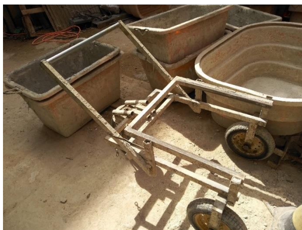
Figura 45 - Carrinho de transporte das caixas de argamassa
