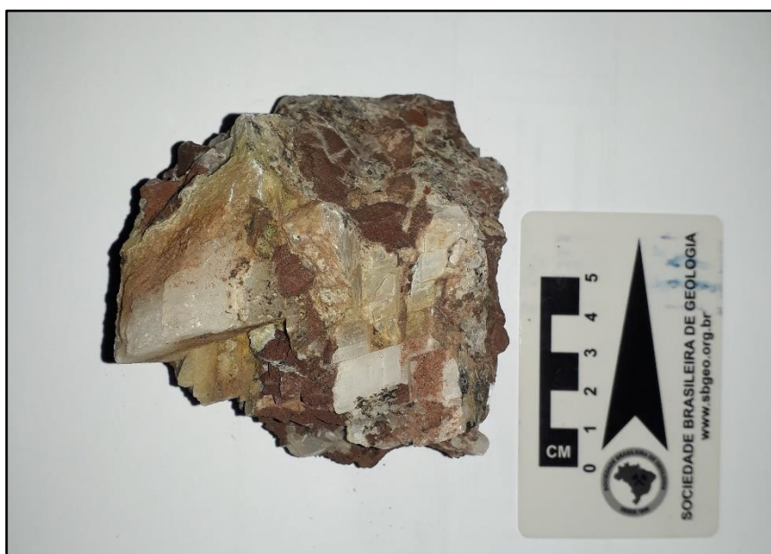
Foto 10. Amostra de brecha hidráulica basáltica preenchida com calcita. (Foto: autor)
