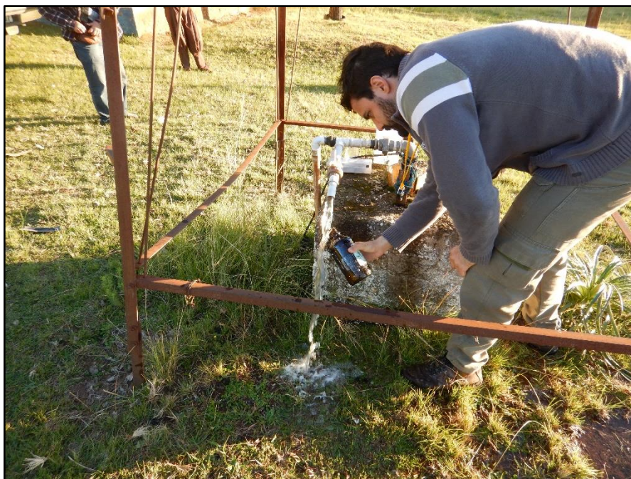
Foto 5. Água sendo coletada em um dos frascos diretamente na saída do poço (Foto: Marcos Leão).
