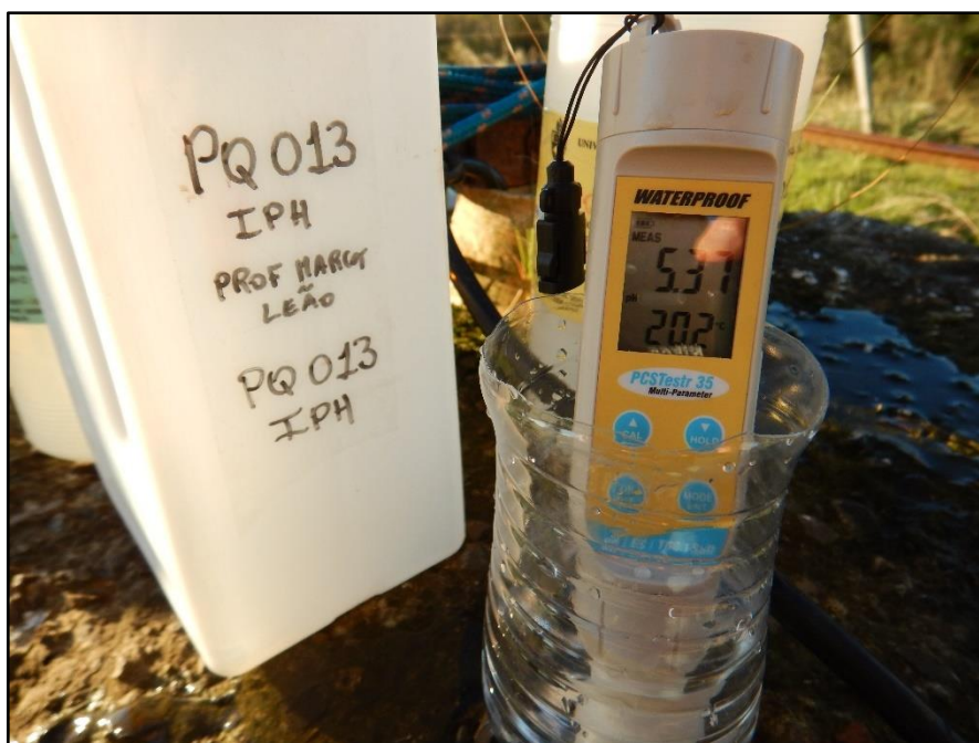
Foto 2. Sonda multi-parâmetros sendo utilizada para medir parâmetros físico-químicos da água de um dos poços visitados (Foto: Marcos Leão).
