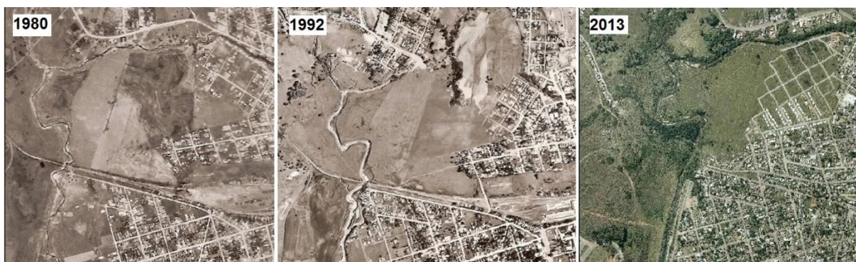
Figura 53 – Recorte comparativo da alteração da sinuosidade entre 1980 e 2013, devido as obras de engenharia a montante que alteraram a hidromorfodinâmica do arroio Cadena, e a jusante assume padrão retilíneo devido as obras de retificação e mudança de leito. Na fotografia de 2013, na área da principal curva do arroio Cadena, percebe-se o aumento da largura das feições sinuosas. Fonte: Iplan. Elaboração: FERRARI, J.
