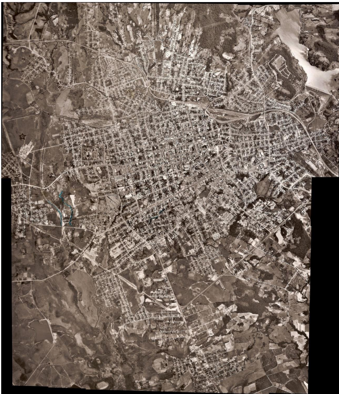
Figura 11 - Mosaico semi-controlado parcial de Santa Maria em 1980, formado a partir de dez fotografias, em três faixas de voos distintas. Elaboração: FERRARI, J.
