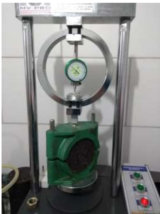
Figura 10 – Prensa utilizada para estabilidade e fluência nos teores preliminares
