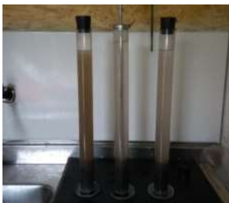
Figura 7 – Ensaio de equivalente de areia
