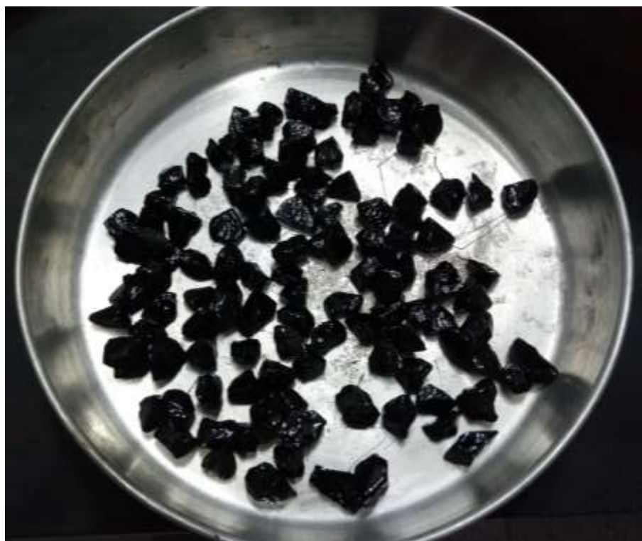
Figura 8 – Ensaio de adesividade
