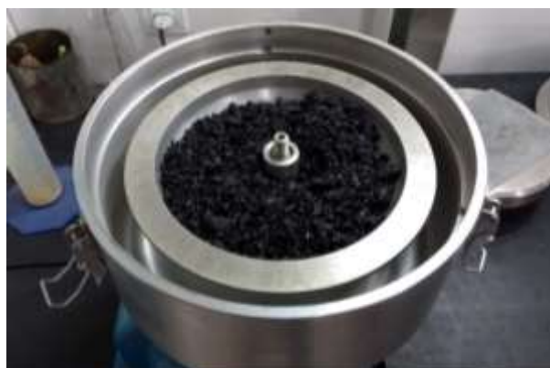
Figura 4 – Ensaio de teor de ligante
