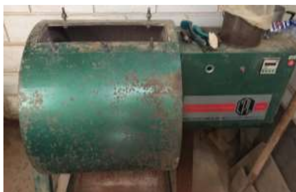
Figura 6 – Ensaio de determinação da abrasão Los Angeles
