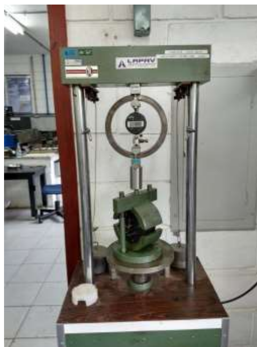
Figura 11 – Prensa utilizada para estabilidade e fluência no teor de projeto
