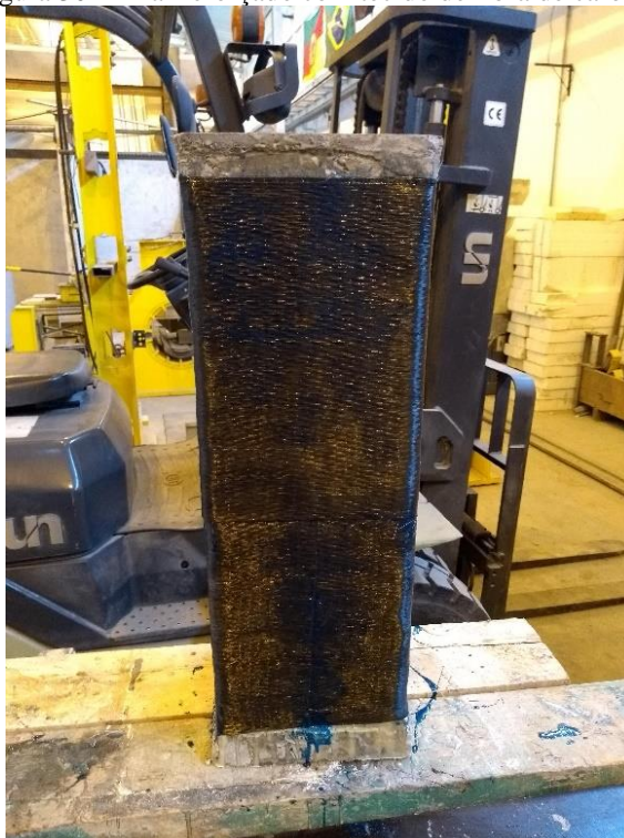
Figura 30 – Pilar reforçado com tecido de fibra de carbono
