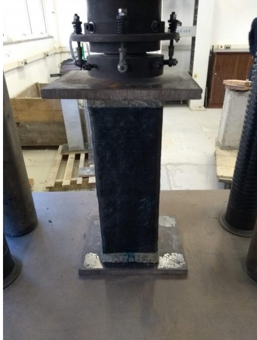
Figura 31 – Ensaio de compressão axial de pilarete reforçado com fibra de carbono
