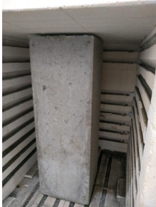
Figura 22 – Posicionamento de pilarete no interior do forno
