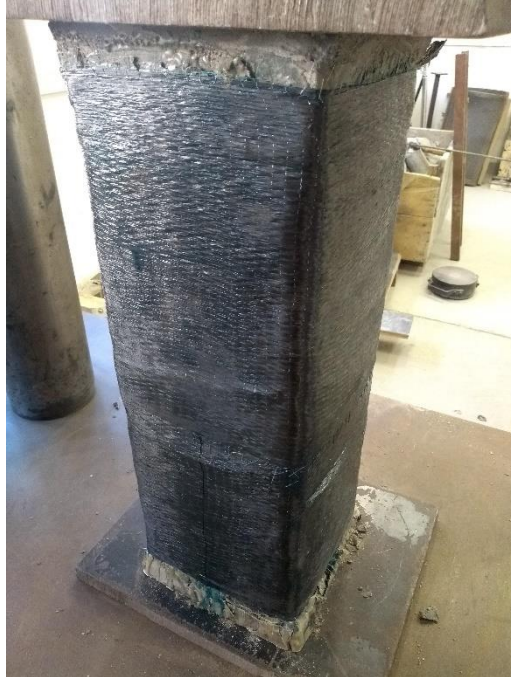
Figura 32 – Detalhe do esmagamento do concreto contido pelo confinamento do reforço CFC
