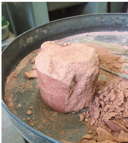
Figura 13 - Retirada da amostra de umidade após a compactação
