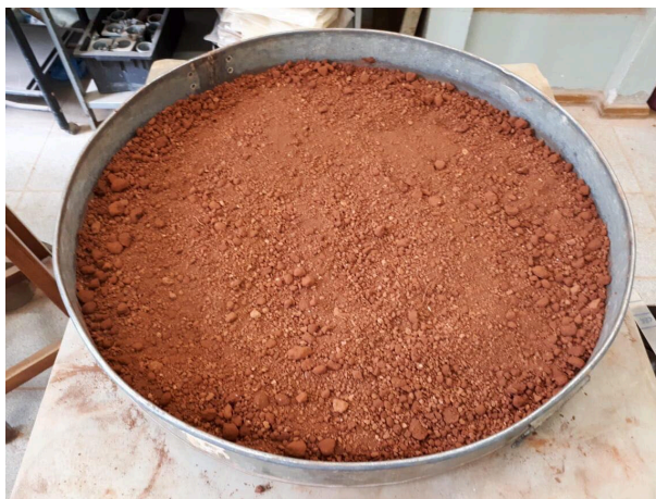
Figura 12 - Preparação do material antes da compactação
