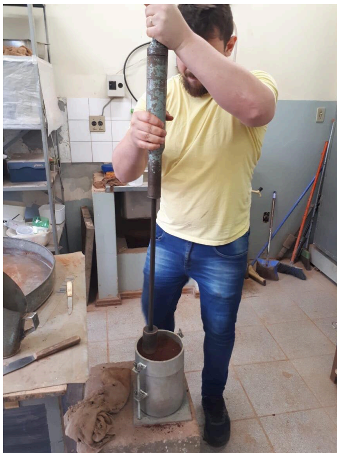
Figura 14 - Compactação do Corpo de Prova
