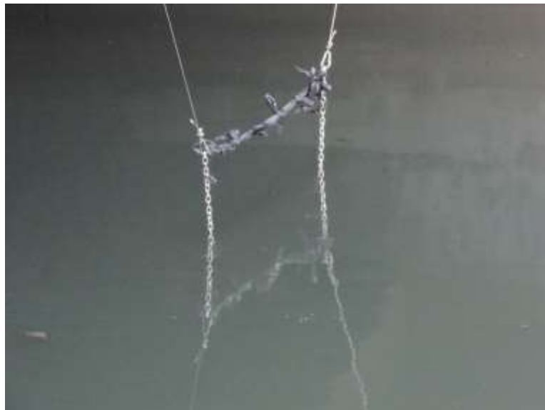
Figura 34 – Armadilha de ferro instalada com a corrente e trabalhando totalmente afogada.
