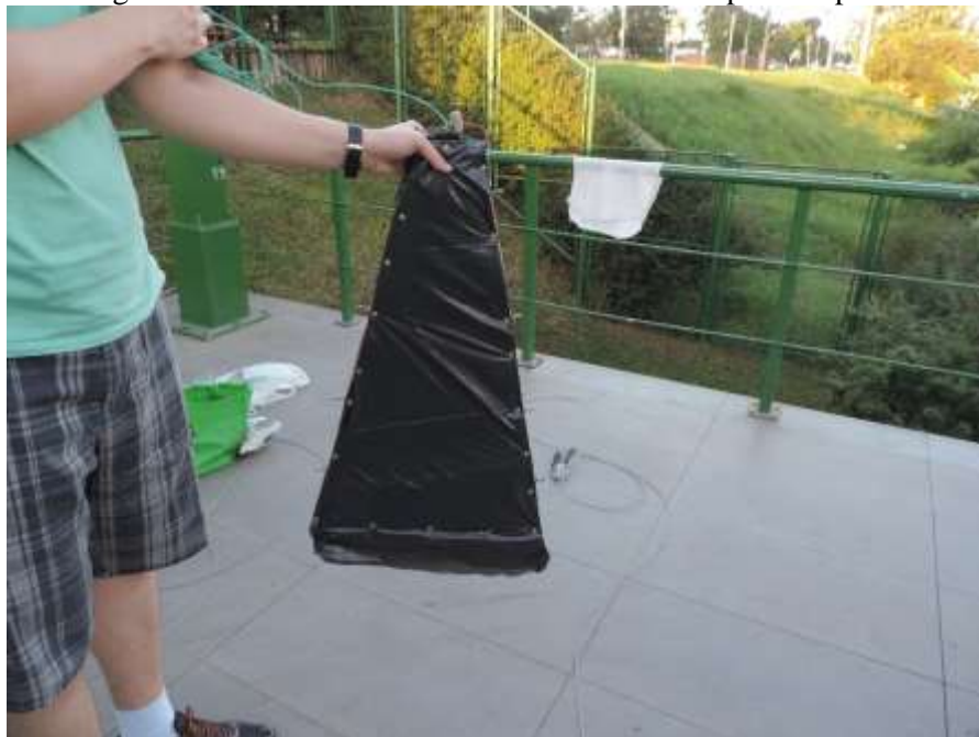
Figura 26 – Armadilha de madeira revestida com plástico preto.
