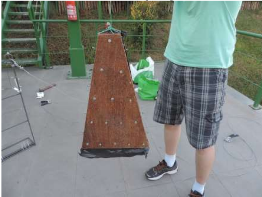
Figura 25 – Armadilha de madeira para capturar RS flutuantes.
