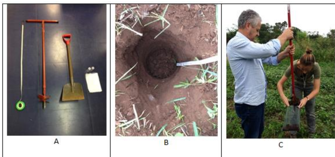
Quadro 1: Materiais utilizados (A), realização e medição da sondagem a trado (B) com coleta de amostra com trado helicoidal (C).
