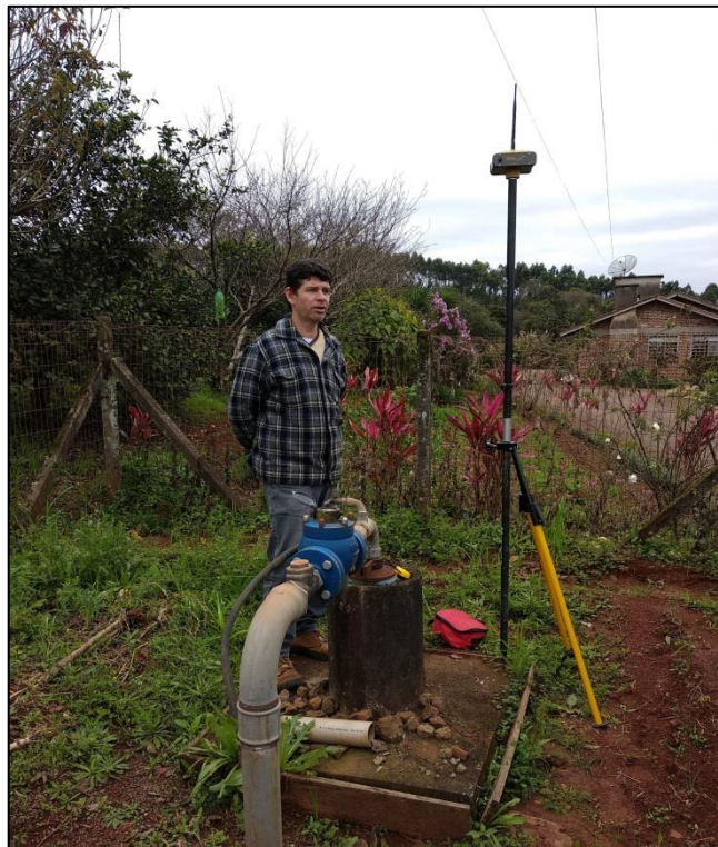
Figura 7. Obtenção das coordenadas X,Y e Z com GNSS de precisão.
