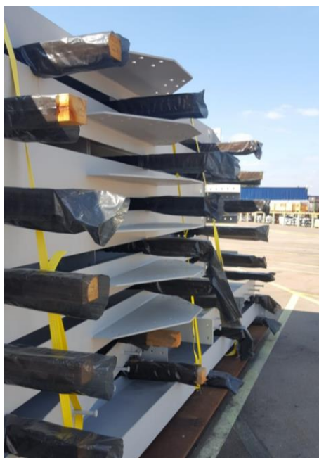
Figura 26 – Carga montada com embalagens garantindo espaçamento entre peças.
