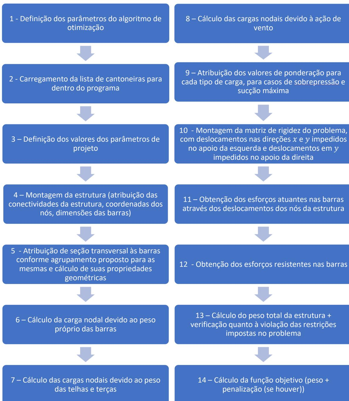
Figura 17 – Sequência dos passos executados pelo programa no processo de otimização. Fonte: o autor
