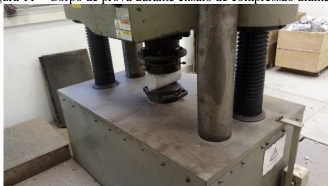
Figura 11 – Corpo de prova durante ensaio de compressão diametral.
