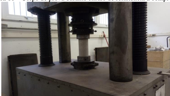
Figura 10 – Corpo de prova durante ensaio de resistência à compressão.
