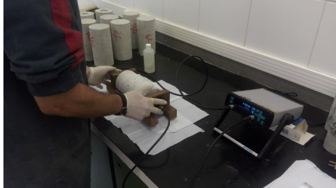
Figura 12 – Corpo de prova durante ensaio de velocidade de pulso ultrassônico.
