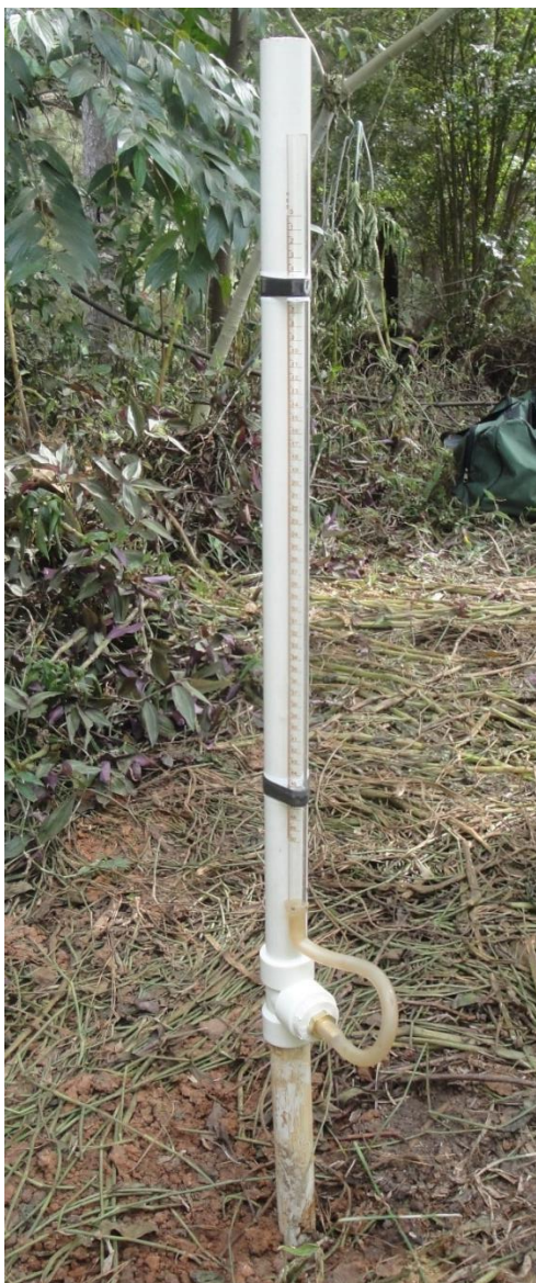
Figura 16 Fotografia do sistema de permeâmetro com medidor de nível de água.
