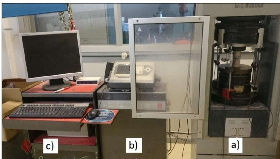
Figura 3.4 Foto da prensa hidráulica utilizada nos ensaios de compressão uniaxial. a) componente do braço da prensa; b) componente do comando da prensa e c) computador.
