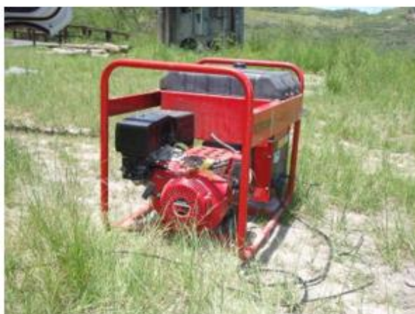
FiguraA-18 – Foto|mostrando o Gerador trifásico
