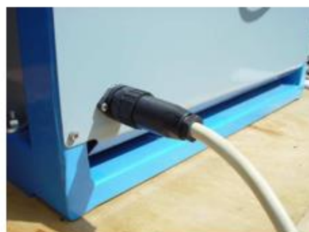
Figura A-17 – Detalhe da frente do guincho com o cabo do controlador conectado.
