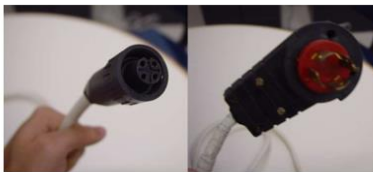
Figura A-15 – Conectores do controlador do Guincho. Conector a direita liga ao guincho e o conector a esquerda é ligado ao gerador de energia.
