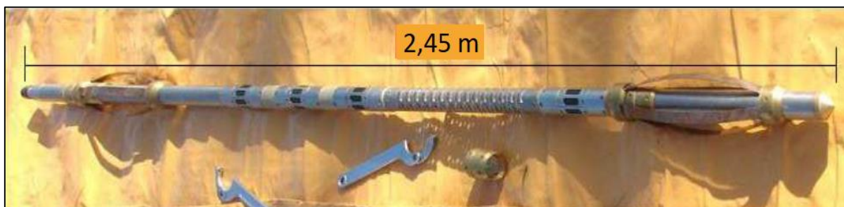
Figura 3.1: Perfilador sônico Slim-Hole Full Waveform Triple Sonic . Utilizado nesta pesquisa.
