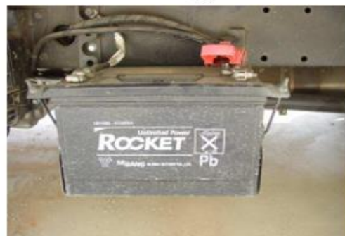
Figura A-13 – Detalhe da bateria do Caminhão utilizada como alimentação do MicroLogger.
