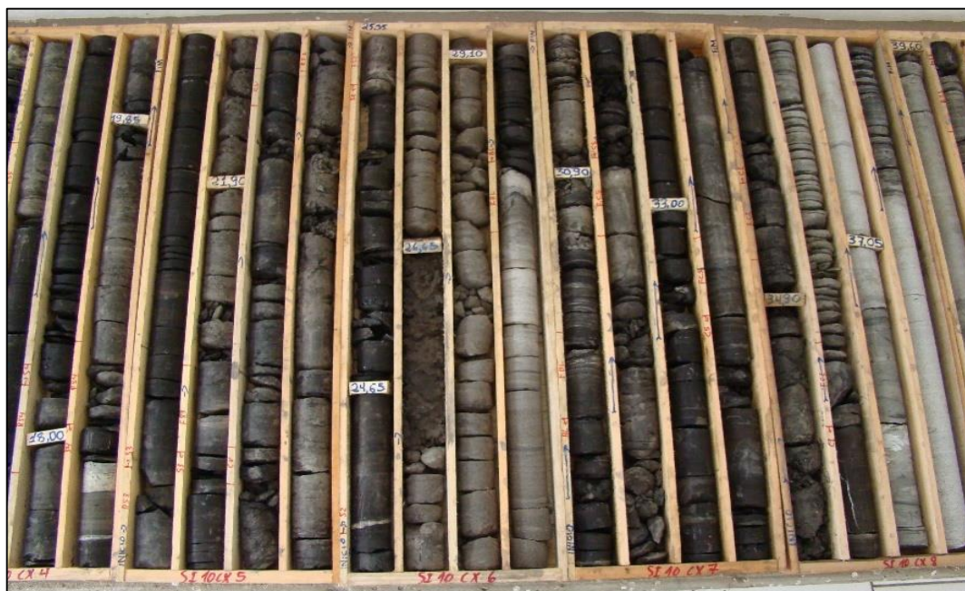
Figura 3.6: Imagem representativa de caixa de testemunhos de sondagem.
