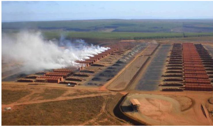
Figura 2.18. Vista aérea de praça de carbonização com fornos retangulares (ArcelorMittal).
