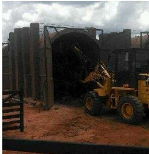
Figura 2.19. Carregamento mecanizado de matéria-prima no forno (Grupo Mutum).
