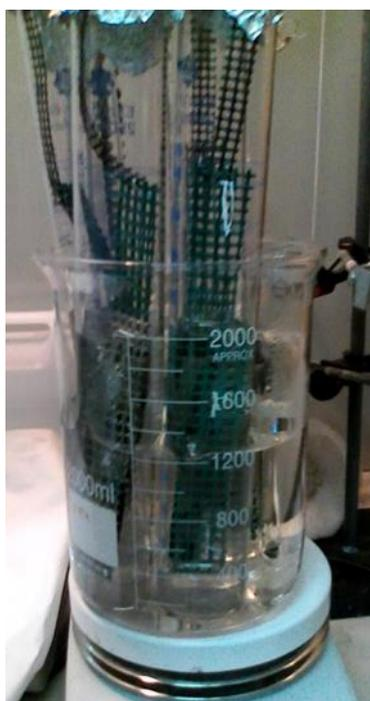
**Figura 2. 9. Síntesis por deposición autocatalítica**
