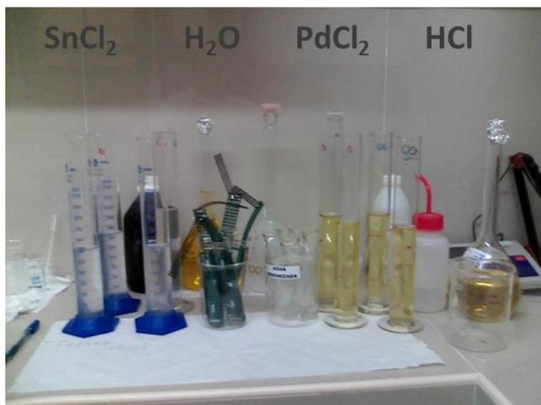
**Figura 2. 8. Etapa de activación en la síntesis catalítica.**
