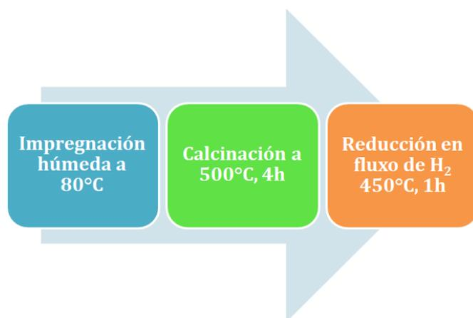
**Figura 2. 4. Esquema de la síntesis catalítica con reducción en fase gas**
