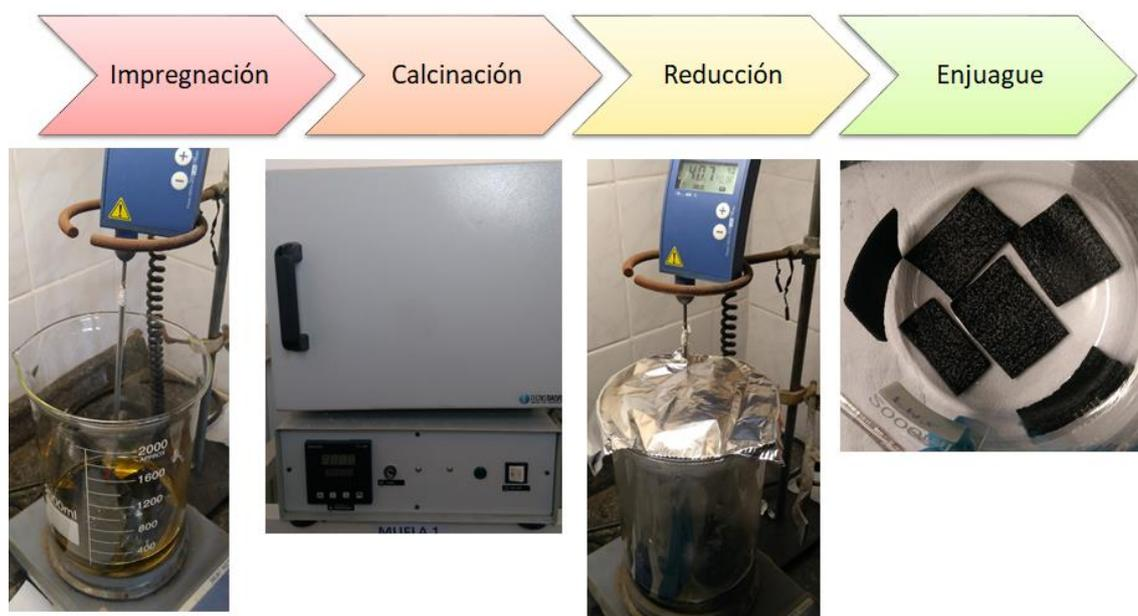
**Figura 2. 11. Impregnación húmeda en fibras de carbono.**
