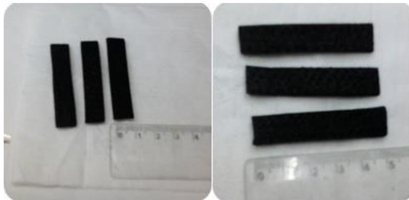
**Figura 2. 2. Fibras de Carbono cortadas en porciones de 5 cm<sup>2</sup>.**
