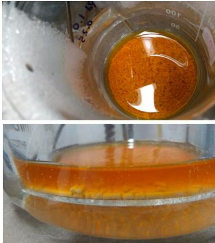
**Figura 2. 3. Proceso de impregnación húmeda en pellets de alúmina con soluciones de PdCl<sub>2</sub> y InCl<sub>3</sub>.**
