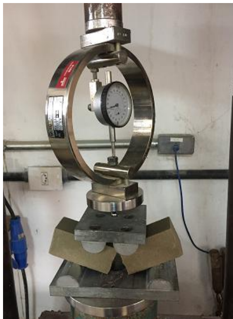
Figura 25 - Modo de ruptura- Mistura Solo-Cimento
