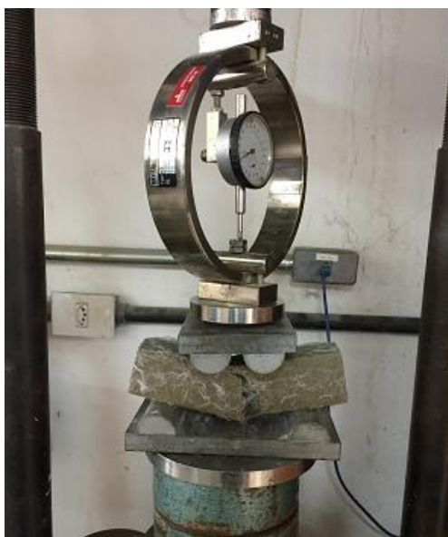
Figura 26 - Modo de ruptura - Mistura Solo-Cimento-Fibra
