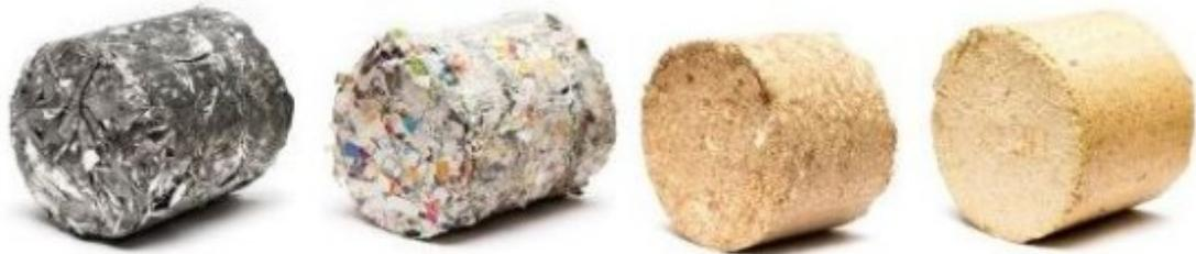
Figura 2: Exemplos de briquetes de alumínio, papel, poeira e serragem, da esquerda para direita. (Fonte: <http://www.maedev.com>, 2018).
