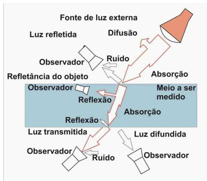
Figura 3.4 – Esquema básico de detecção visual ativa [Adaptado de Ogawa, 2011].
