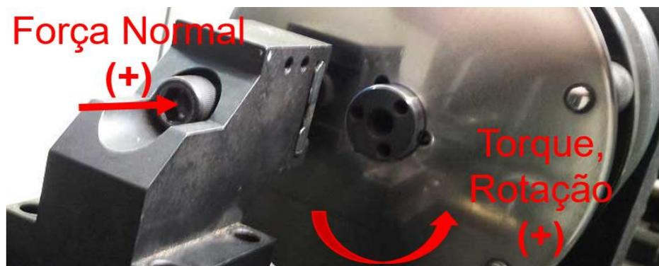
Figura 4.2: Convenção de sinais utilizada pelo sistema atual de medição do tribômetro.
