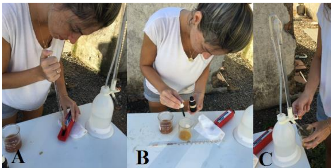
Figura 9 - Utilização do refratômetro (A); adição de azul de bromotimol no mosto (B); Realização da titulação através da adição da solução de hidróxido de sódio (C).
