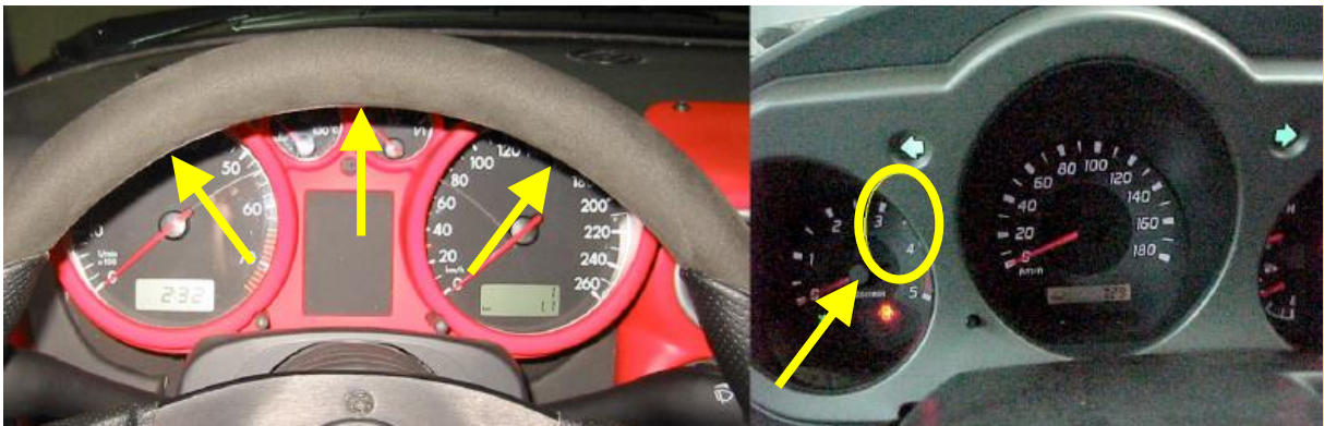
Figura 27: Exemplos de obstruções visuais nos painéis de instrumentos
