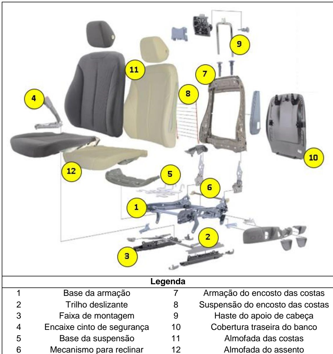
Figura 10: Vista explodida de um assento automotivo
