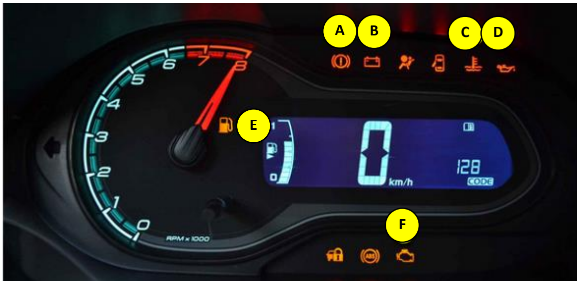
Figura 29: Símbolos normatizados presentes no display do painel
