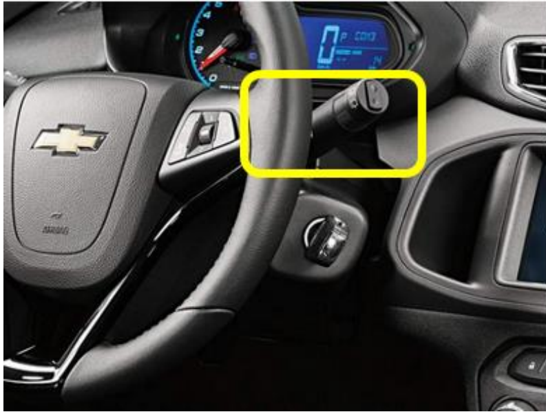
Figura 26: Posição esperada para o limpador de para-brisa
