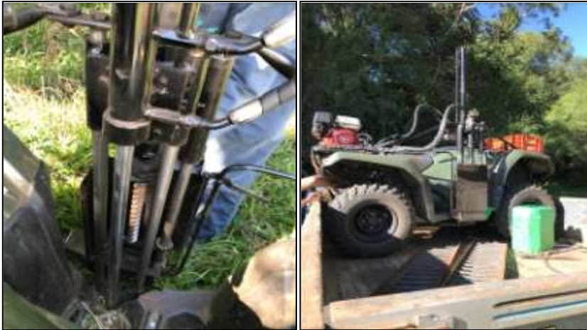
Figura 11 - Coletor de solo automatizado acoplado no quadriciclo.
