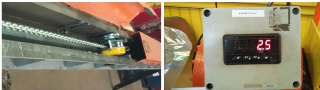
Figura 54 - Teste de ancoragem da talha- 2,5 toneladas.
