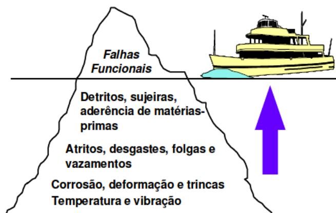
Figura 2 - Causa das falhas funcionais.
