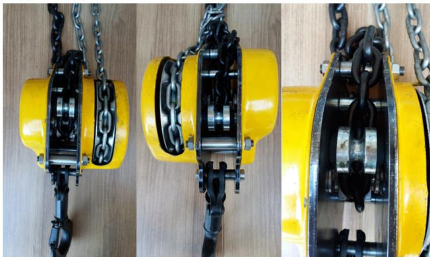
Figura 57 - Conjunto do protótipo após ensaio de sobrecarga.
