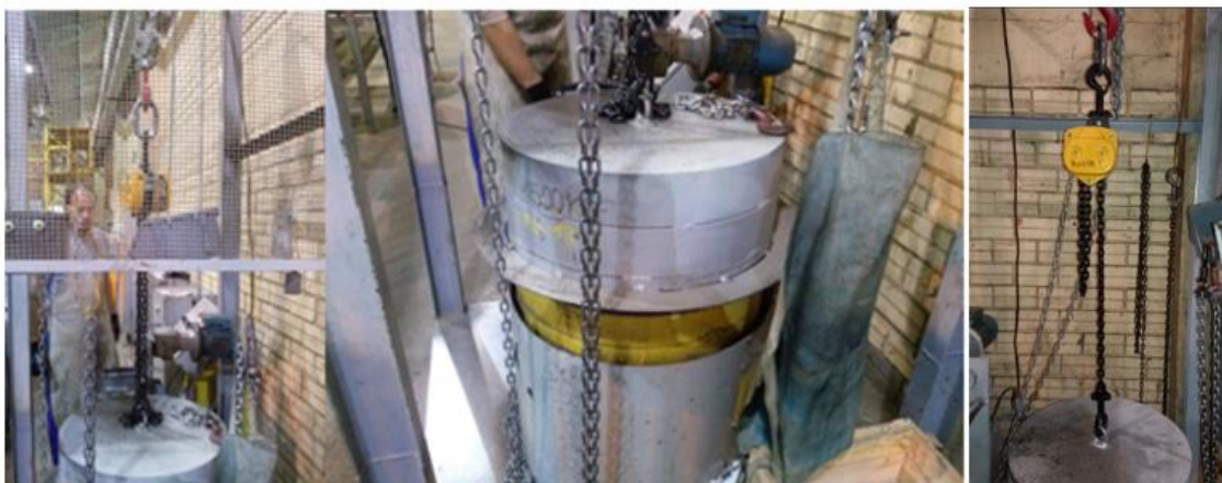
Figura 52 - Teste de carga nominal no protótipo da talha.
