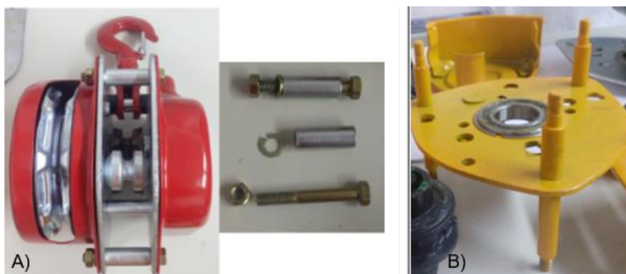
Figura 36 - Detalhe de fixação das talhas- Sistema de fixação com espaçador (A) - Sistema de fixação com eixo (B).
