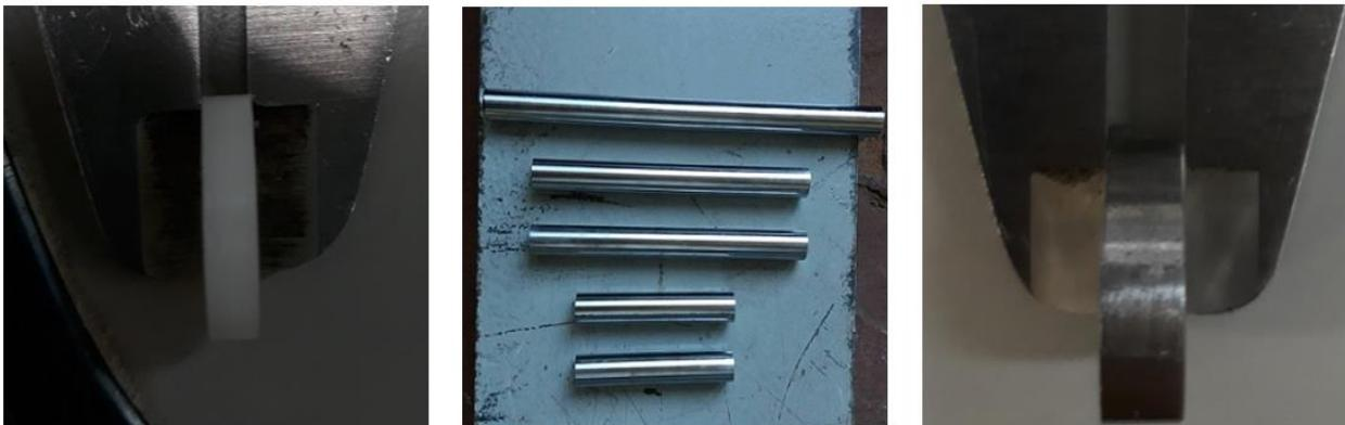
Figura A.6 – Corpo de prova de POM (esquerda), corpo de prova de alumínio (direita) e projéteis (centro)
