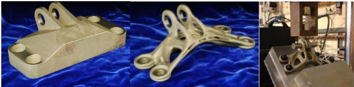
Figura 1.1 - Otimização topológica aplicada a suporte de turbinas de avião. [GE Challenge, 2018]
