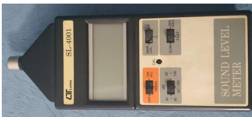
Figura 2: Decibelímetro utilizado na obtenção dos dados.
