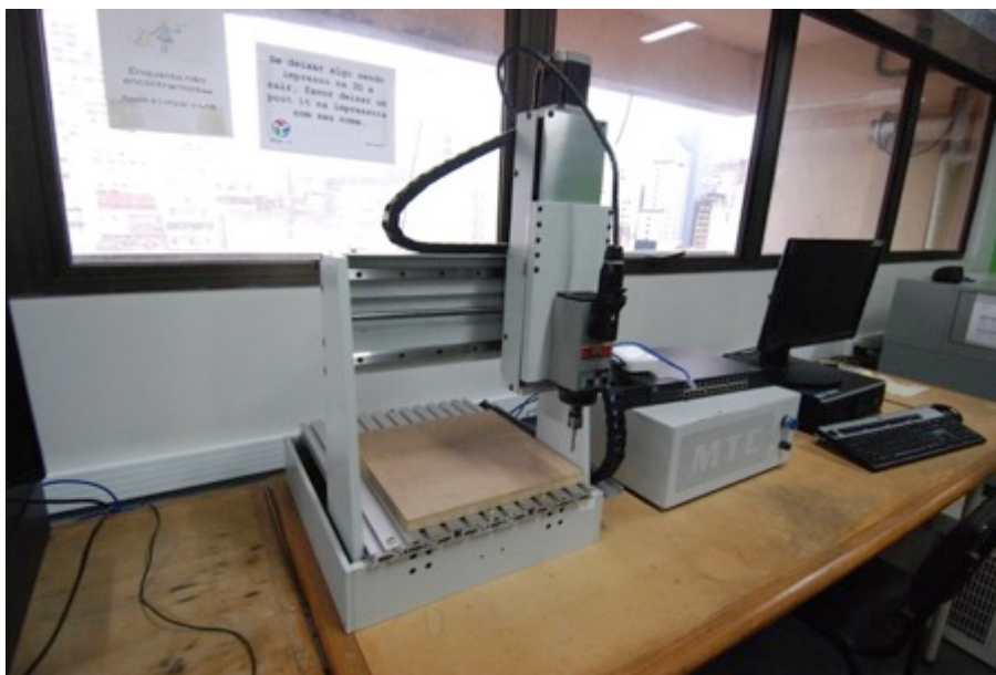
Figura 73 - Fresadora de precisão disponível no POALab
