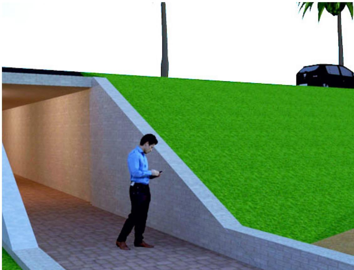
Figura 199. Simulação: render projeto original demonstra que a luminosidade do túnel subterrâneo ocorre de forma mais intensa quando a entrada está no mesmo nível da área externa.
