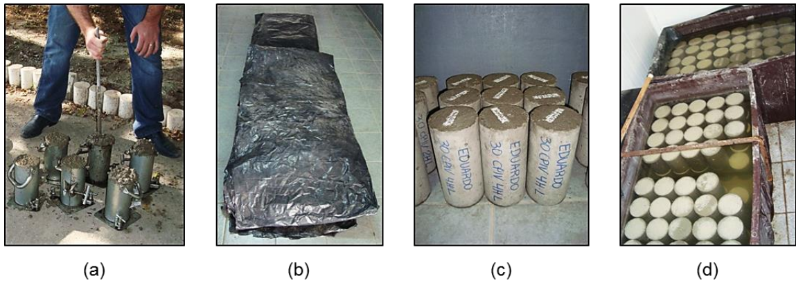
Figura 29: procedimento de moldagem e cura dos corpos de prova: (a) moldagem dos corpos de prova, (b) cura inicial, (c) identificação e (d) cura final
