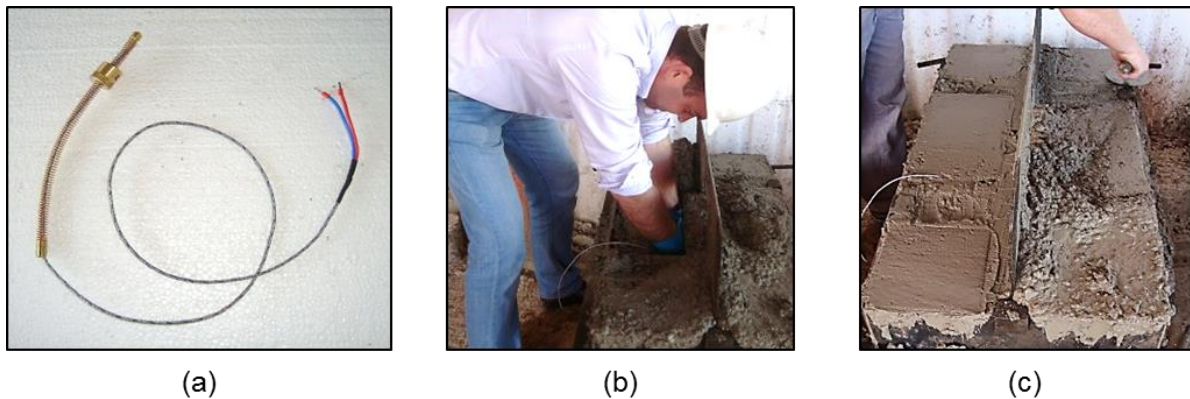
Figura 38: (a) modelo de termopar utilizado, (b) posicionamento do termopar no centro do bloco de concreto e (c) proteção do termopar e acabamento final do bloco
