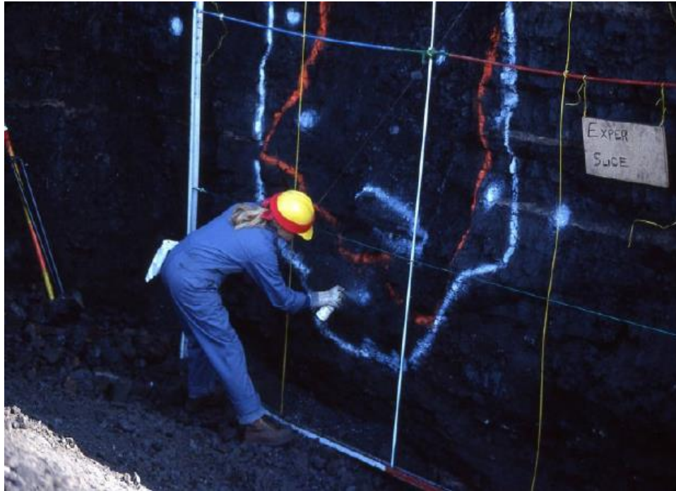
Figura 18. Experimento em Grandes Blocos em Centralia. Podemos evidenciar em Branco, a zona afetada da camada de carvão, e em laranja o formato assimétrico da cavidade gerada durante o UGC.
