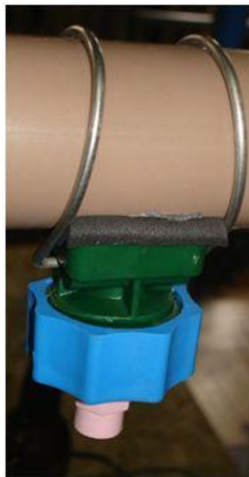
Figura 4.4. Bico de spray, para cone cheio com ângulo de abertura de 60^\circ .
