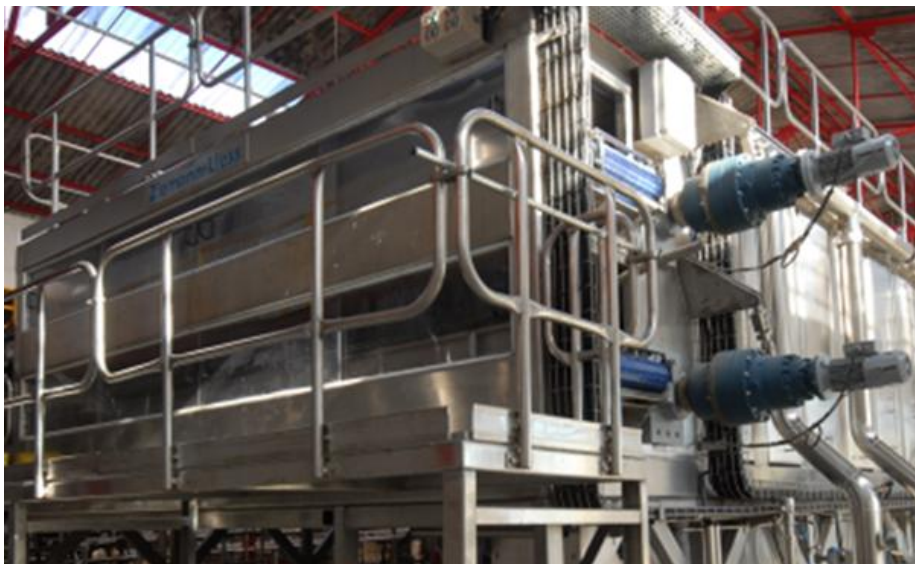
Figura 2.14. Parte frontal de um túnel pasteurizador em aço inoxidável, com acionamento por motoredutores planetários (Ziemann-Liess Ltda).
