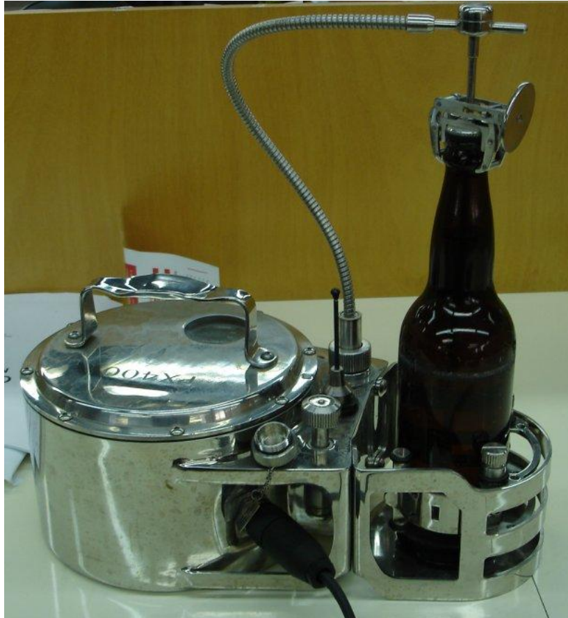
Figura 4.7. Termógrafo para medição da temperatura no vasilhame.
