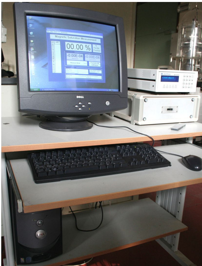
Figura 4.6: Equipamento utilizado para medição de saturação magnética dos materiais.
