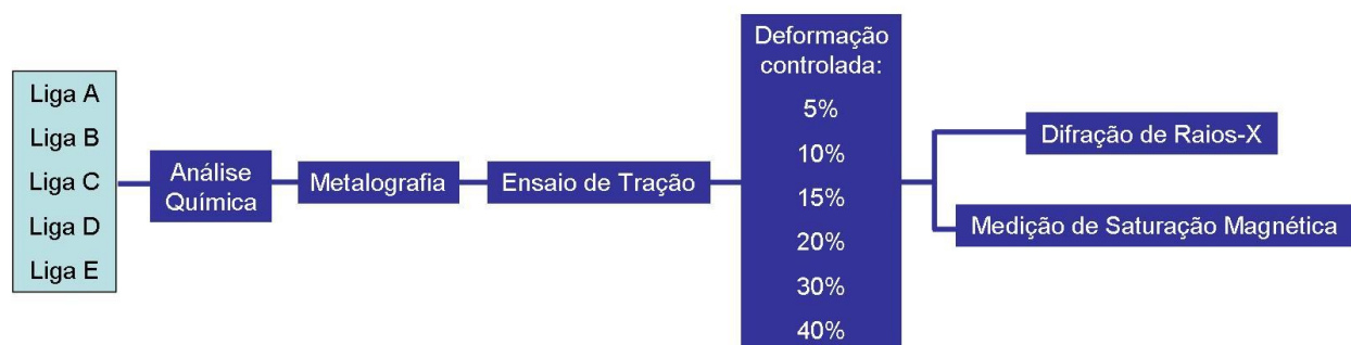
Figura 4.1: Fluxograma de procedimento usado para avaliação das ligas.
