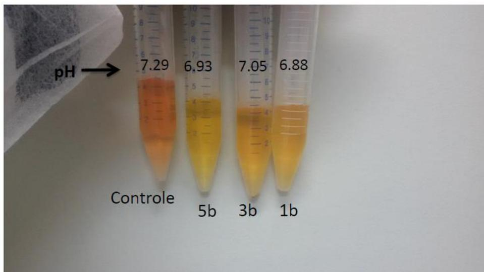
Figura 28: Variação do pH das amostras do experimento de citocompatibilidade #1. Da esquerda para a direita PGS controle, PGS/PPy 5% (5b), PGS/PPy 3% (3b) e PGS/PPy 1% (1b).
