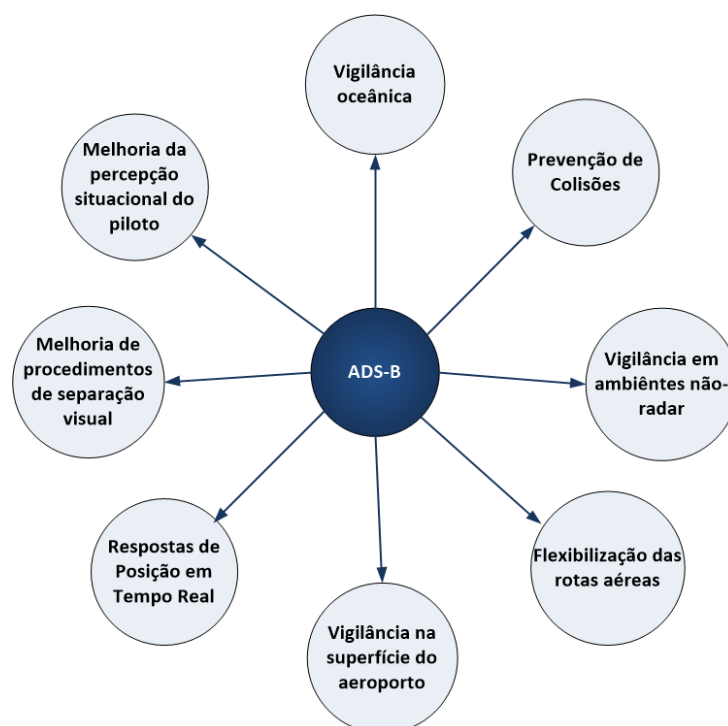
Figura 2 – Diagrama de possibilidades funcionais que podem ser alcançadas com o uso do sistema ADS-B.
