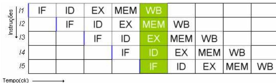
Figura 2.3: Tempo de execução com *pipeline* (Adaptado de Patterson, 2005)
