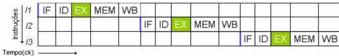
Figura 2.2: Tempo de execução sem *pipeline* (Adaptado de Patterson, 2005)
