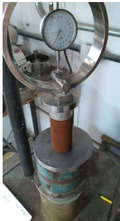
Figura 3.3 – Prensa e anel utilizados no ensaio de compressão simples.
