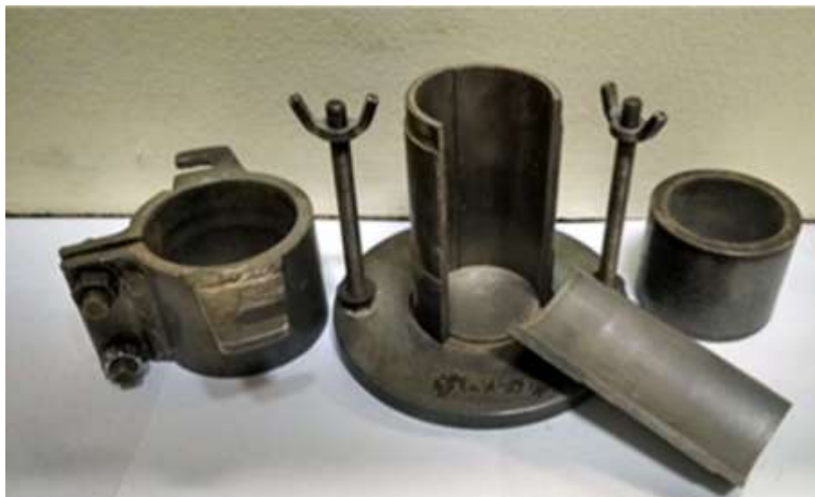
Figura 3.1 – Molde tripartido utilizado na moldagem dos corpos de prova (adaptado de MARQUES, 2016).
