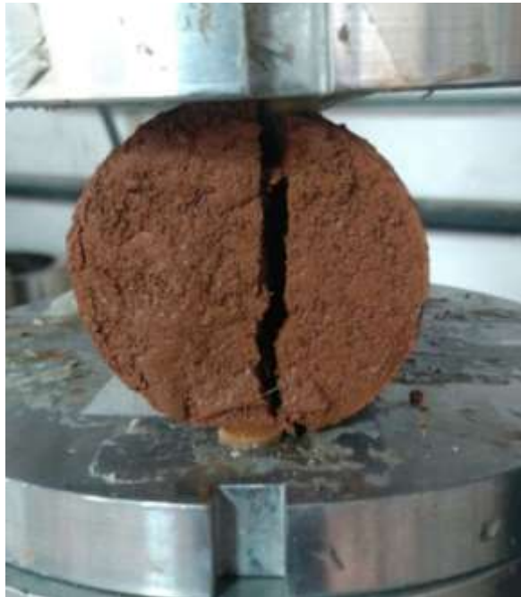
Figura 3.4 – Ensaio de compressão diametral: ruptura típica.
