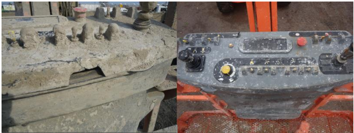
Figura 8. Painel de Controle da PTA Entregue pela Obra X PTA Recebida na Obra
