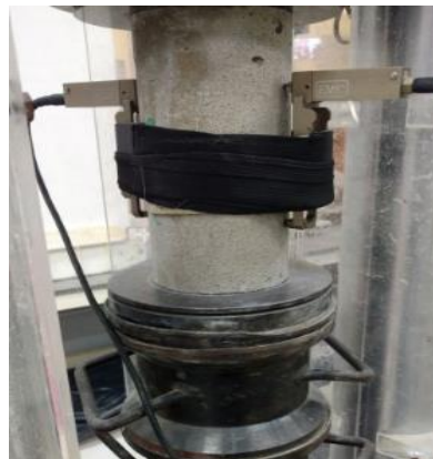
Figura 25- Ensaio de módulo de Elasticidade
