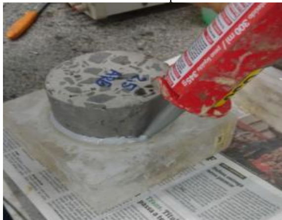
Figura 29- Acoplamento da amostra nas célula com selante PU à base de poliuretano
