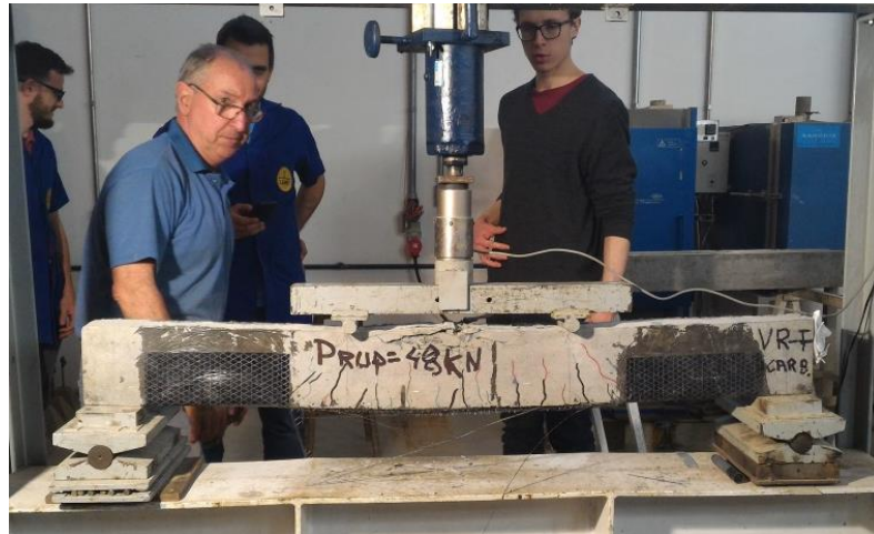
Figura 9: Rompimento reforço chapa colada 2017/1
