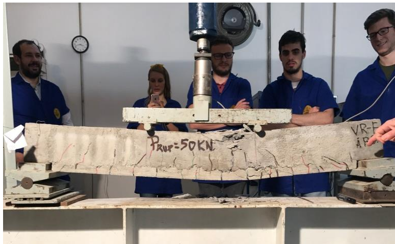
Figura 7: Rompimento reforço chapa colada 2017/1
