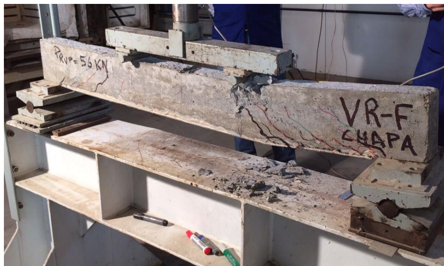
Figura 5: Rompimento reforço chapa colada 2017/1
