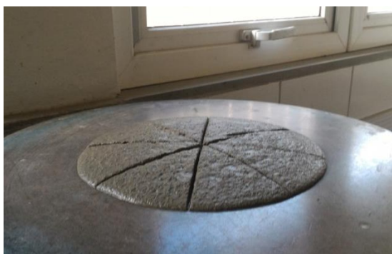
Figura 36: Ensaio de abatimento para verificação do índice de consistência
