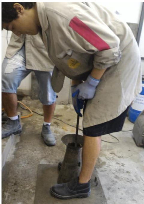
Figura 33: Determinação da consistência pelo abatimento do tronco de cone
