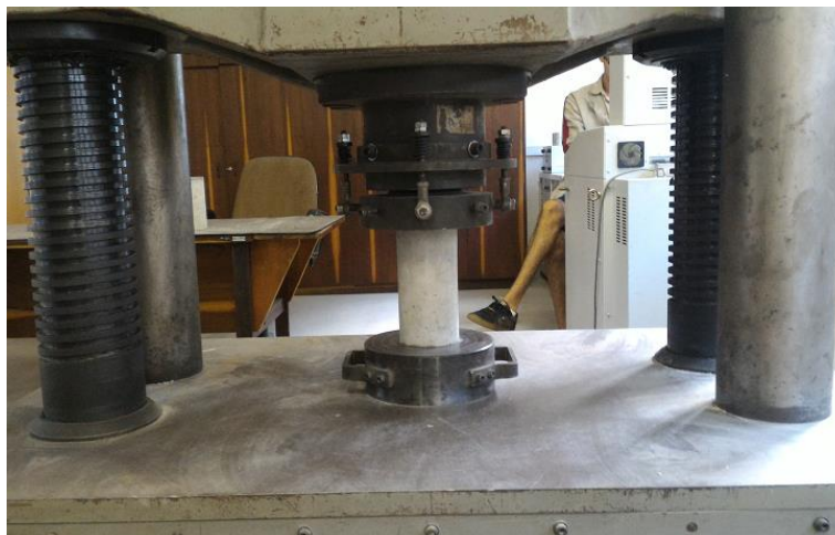
Figura 35: Rompimento do CP de concreto
