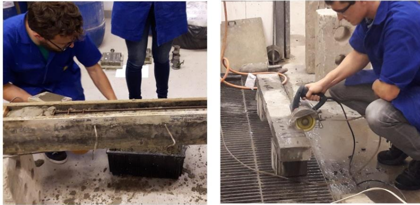
Figura 6: Execução reforço armadura incorporada com argamassa
