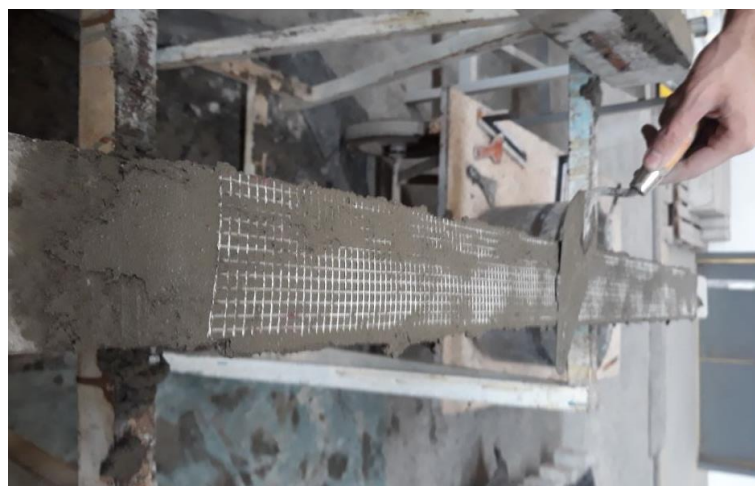
Figura 43: Aplicação do reforço – imersão do têxtil FiberTEX
